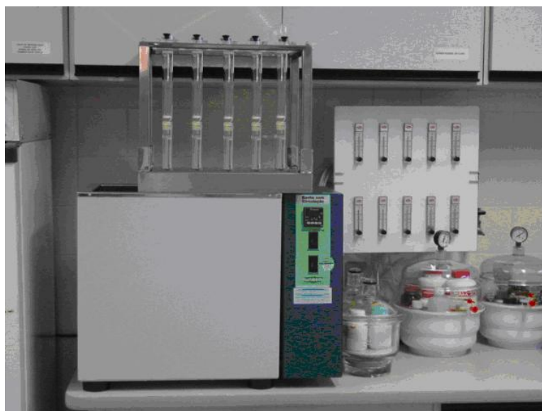
Figura 4.1: Reator de colunas de vidro com banho termostático
