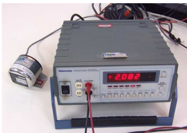
Figura 20. Transdutor de pressão Setra conectado ao multímetro digital Tektronix.
