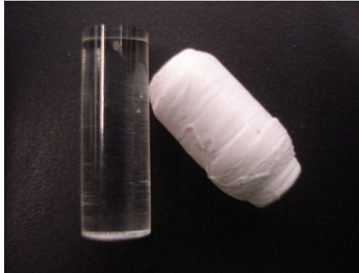
Figura 11: Foto do cintilador utilizado no experimento: à esquerda, sem a capa de teflon; à direita, com a capa.
