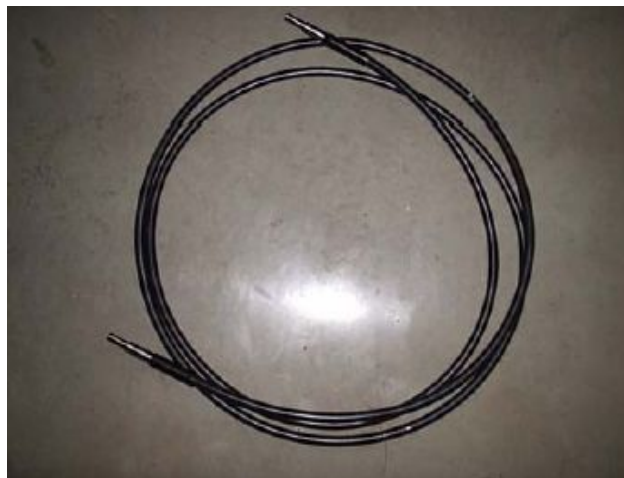
Figura 12: Foto do guia líquido de luz utilizado no experimento.
