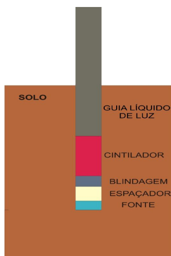
Figura A.2: Ilustração da geometria modelada através do código MCNP.
