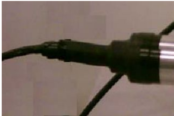
Figura 13: Foto do acoplamento do guia líquido de luz à fotomultiplicadora.
