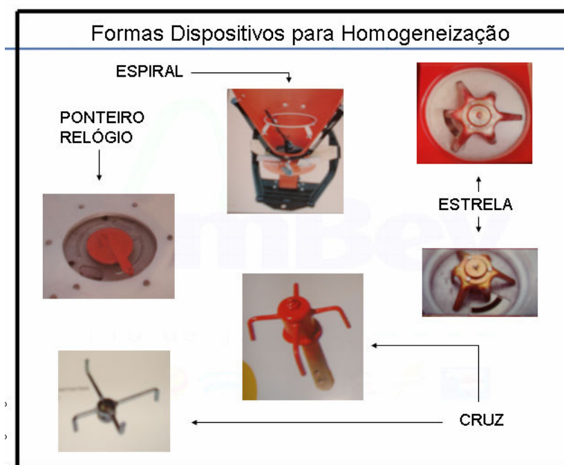
Figura 14 – Formas de dispositivos encontrados na pesquisa para a homogeneização do produto no reservatório.
