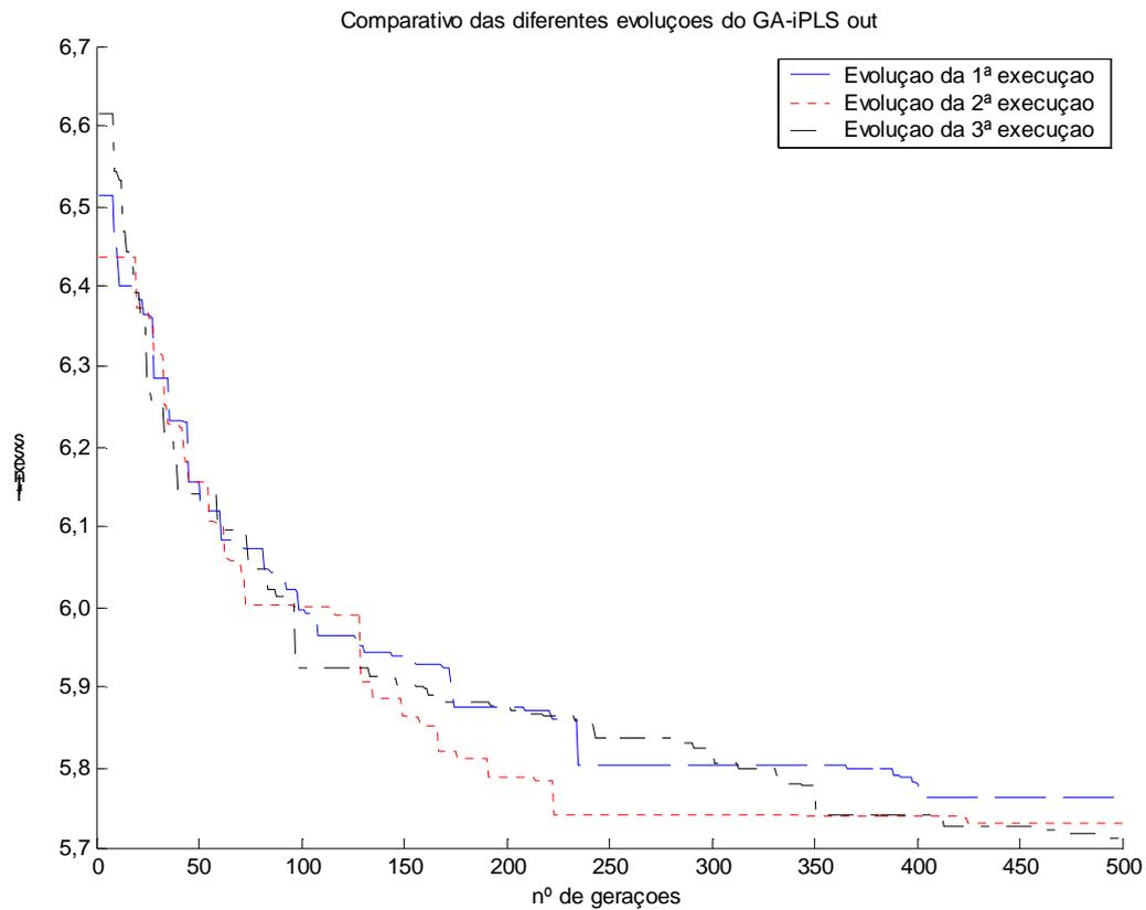
Figura 22 - Evoluções das três execuções do GA-iPLS out para a determinação de OH em polióis de óleo de soja, dividindo o espectro em 60 intervalos
