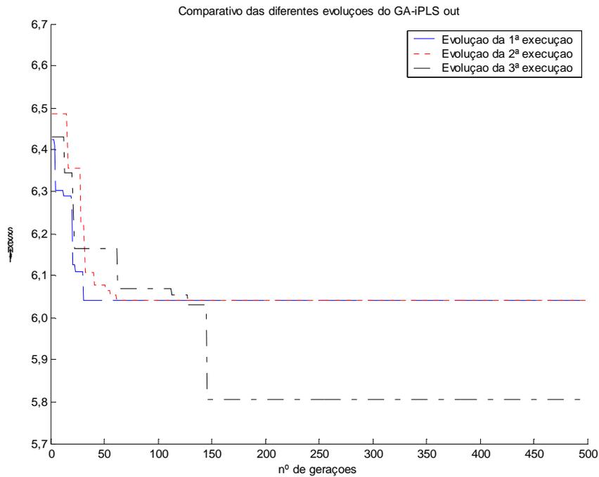
Figura 20 - Evoluções das três execuções do GA-iPLS out para a determinação de OH em polióis de óleo de soja, dividindo o espectro em 20 intervalos
