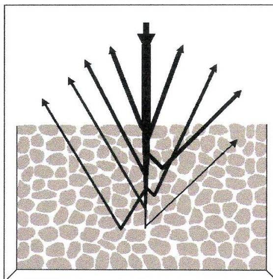
Figura 1 - Reflexão especular e difusa de uma onda eletromagnética em uma amostra.
