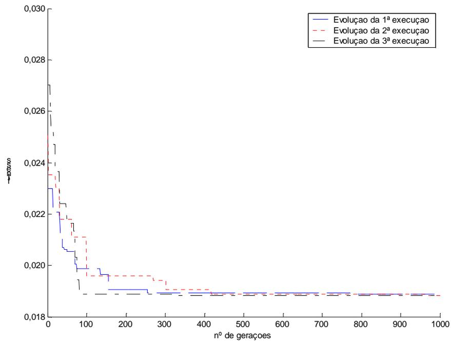
Figura 34 – Evoluções das três execuções do GA-iPLS *out* para a determinação de concentração de cloridrato de propranolol, dividindo o espectro em 25 intervalos
