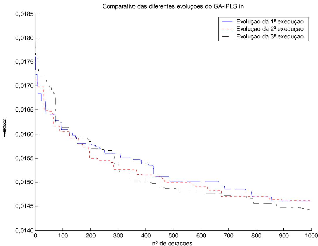
Figura 41 – Evoluções das três execuções do GA-iPLS *in* para a determinação de concentração de cloridrato de propranolol, sobre a melhor resposta do GA-iPLS *out* com o espectro dividido em 100 intervalos
