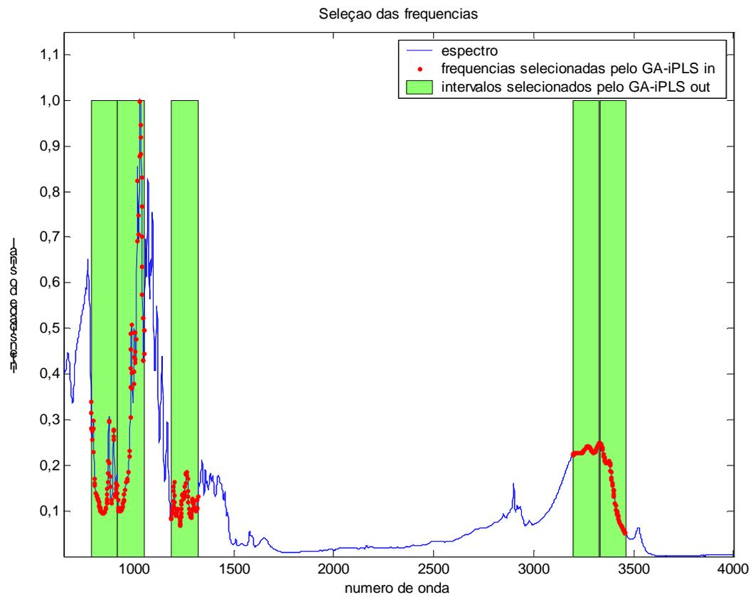
Figura 42 – Espectro de amostras de cloridrato de propranolol, ressaltando as regiões selecionadas pelo método GA-iPLS *in*, sobre a solução encontrada pelo GA-iPLS *out* com o espectro dividido em 25 intervalos
