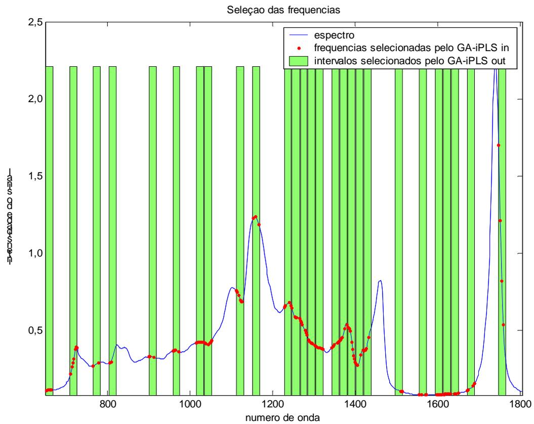
Figura 28 – Espectro de polióis de óleo de soja, ressaltando as regiões selecionadas pelo método GA-iPLS in, sobre a solução encontrada pelo GA-iPLS out com o espectro dividido em 60 intervalos
