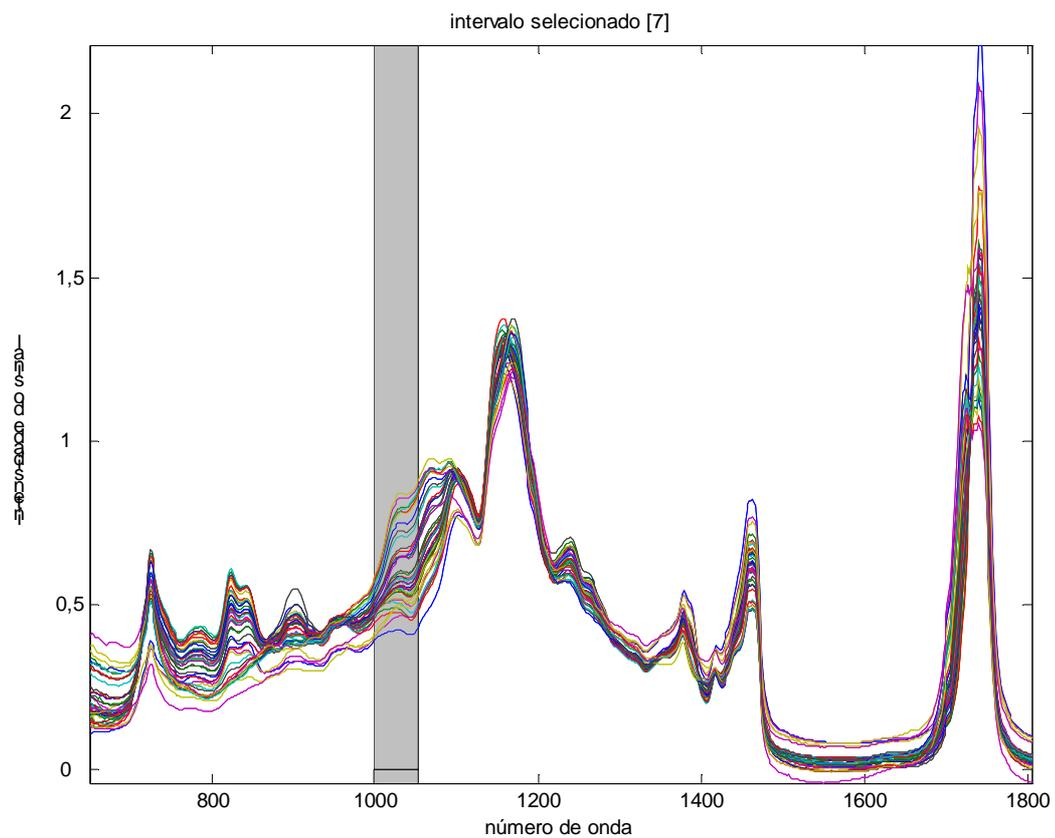
Figura 18 – Espectro de polióis de óleo de soja, ressaltando a região selecionada pelo método iPLS com o espectro dividido em 20 intervalos
