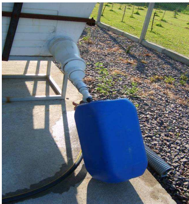
Figura 5: Coleta de efluentes secundário para ensaios de desinfecção na saída do Wetland 2.
