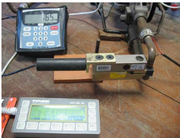
Figura 3.17 – Calibração da força aplicada pela pinça.
