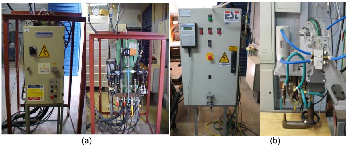
Figura 3.1 – Fontes presentes no Laposolda: (a) Corrente alternada e baixa frequência (LF/AC); (b) Corrente contínua e média frequência (MF/DC).
