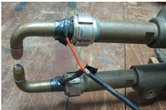
Figura 3.5 – Tomada de tensão para monitoração do sinal de tensão
