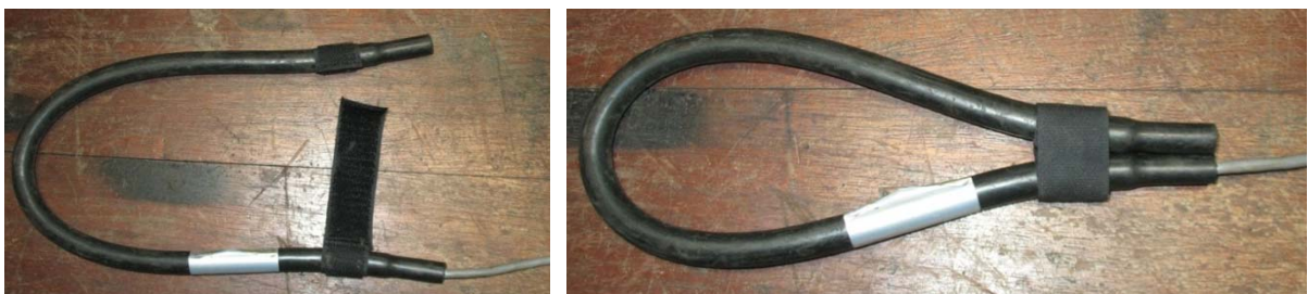
Figura 3.11 – Bobina flexível utilizada para medir o sinal de corrente nos experimentos
