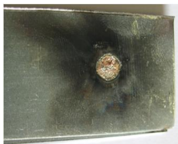
Figura 5.5 – Parâmetros excessivos para a espessura da chapa (0,7 mm), ensaio BZ03
