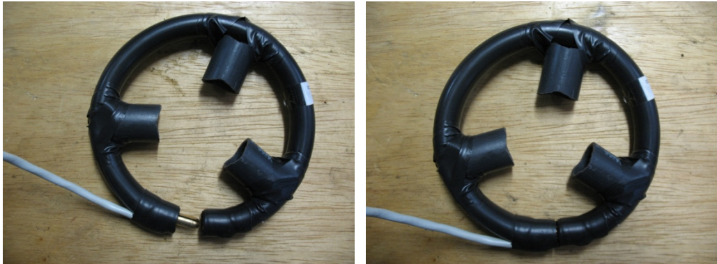
Figura 3.12 – Bobina rígida utilizada para medir o sinal de corrente nos experimentos
