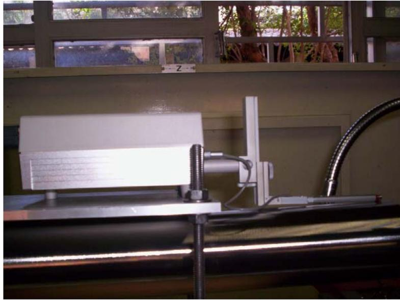
Figura 3.4 – Medição da rugosidade utilizando um rugosímetro digital.
