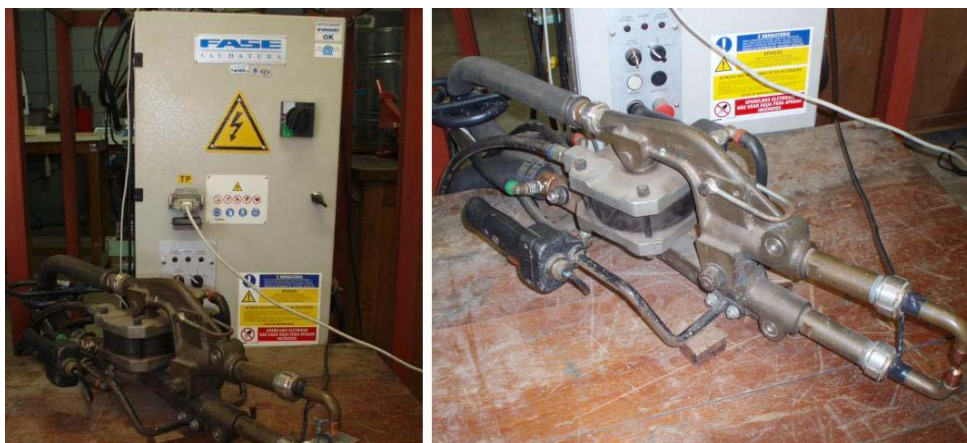
Figura 3.1 – Controlador (a) e pinça de soldagem pneumática (b) do equipamento de soldagem por Corrente Alternada (AC).
