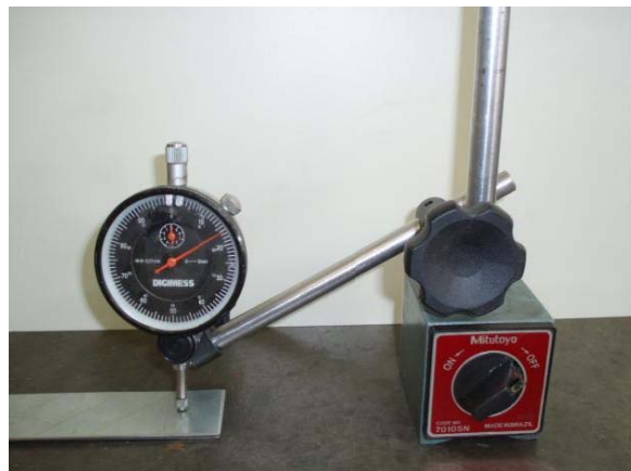
Figura 3.7 – Relógio comparador acoplado à base magnética para a realização das medições de indentação.
