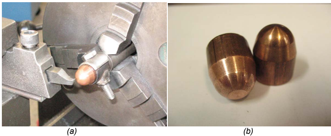
Figura 3.17 – Método utilizado para a confecção dos eletrodos truncados a partir da usinagem dos eletrodos dome (a) e eletrodos antes e após a usinagem (b).
