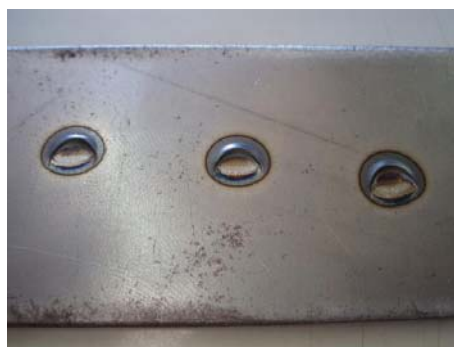
Figura 4.1 – Pontos de solda realizados pelo equipamento AC, evidenciando o desalinhamento dos eletrodos durante a aplicação de eletrodos truncados.
