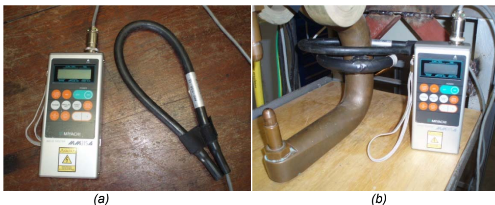
Figura 3.14 – Analisador de soldagem Miyachi e bobina toroidal utilizada para as medições da corrente de soldagem.
