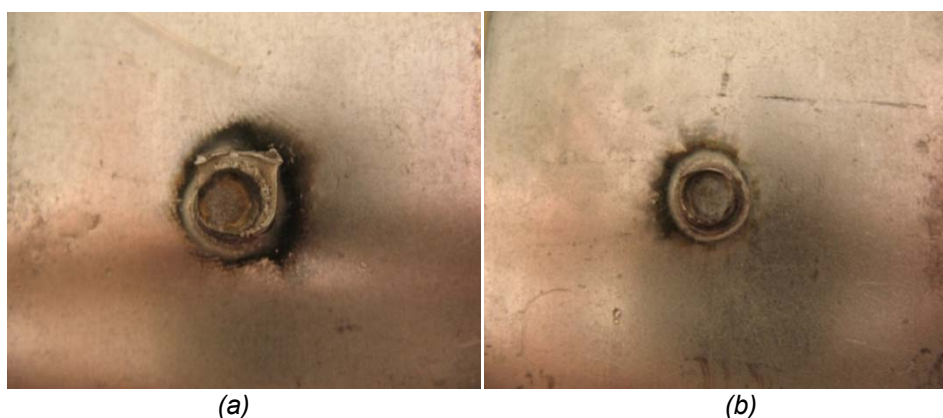
Figura 5.9 – Arrancamento do botão fora da zona afetada pelo calor contendo parte do metal de base (a) e Arrancamento do botão na zona afetada pelo calor rente à lente de solda (b).
