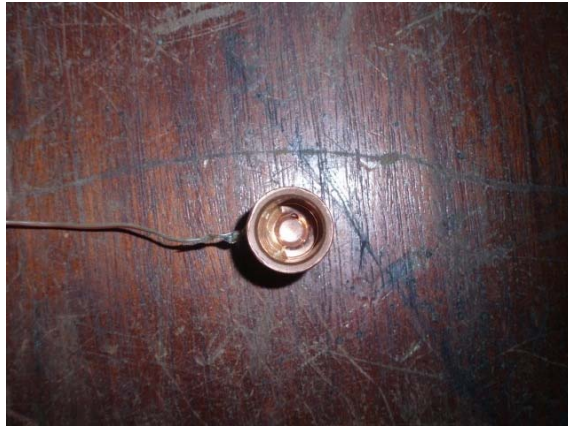
Figura 3.19 – Instalação do termopar junto à parede interna do eletrodo.
