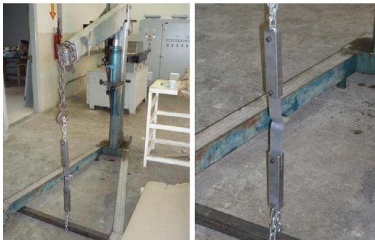
Figura 3.5 – Sistema de arrancamento mecânico elaborado para facilitar o trabalho de medição do diâmetro dos botões de solda.
