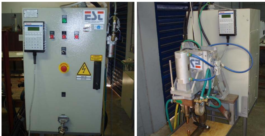
Figura 3.2 - Controlador (a) e pinça de soldagem pneumática (b) do equipamento de soldagem por Média Freqüência Corrente Contínua (MFDC).
