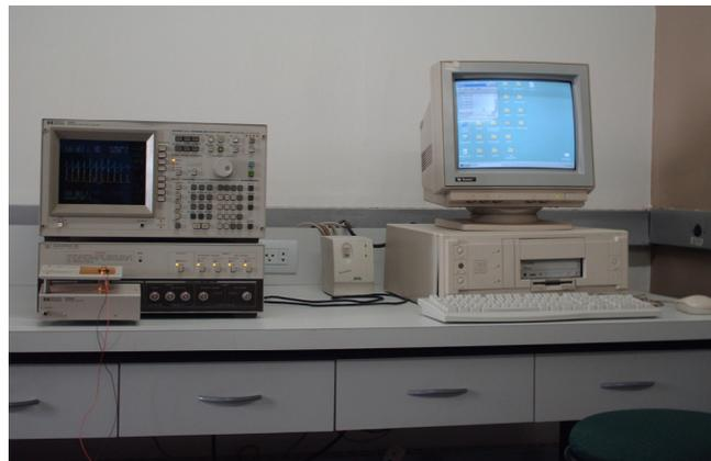
Figura 2.3- Analisador de impedância HP 4194A.
