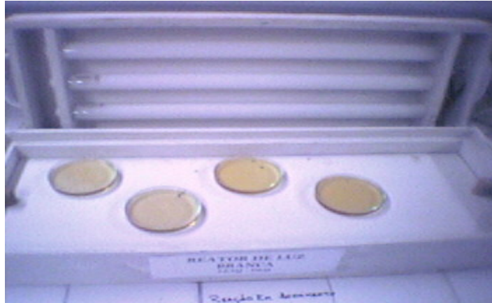
Figura 3.3 - Reator com luz branca
