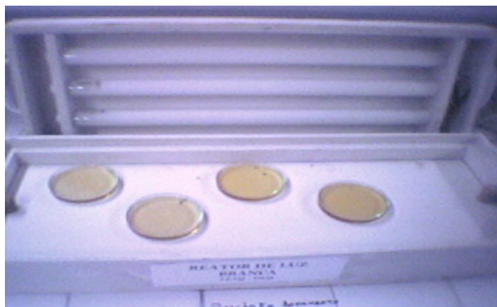
Figura 4.2 - Lixiviado após tratamento POA em reator com luz branca
