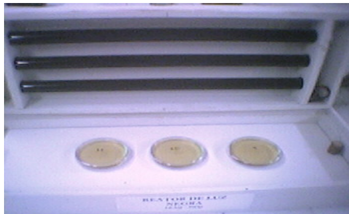
Figura 3.2 - Reator com luz negra
