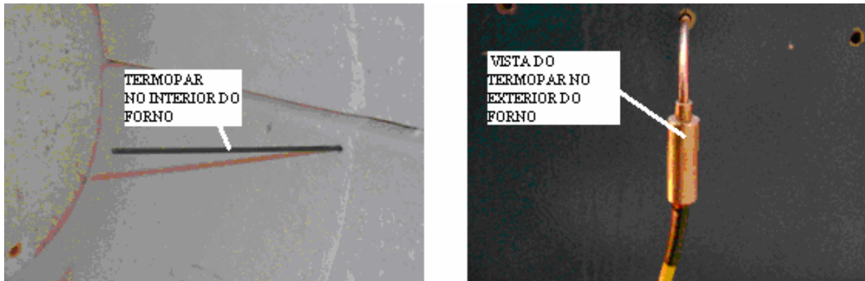
Figura 3.8: Localização do sensor de temperatura (termopar).
