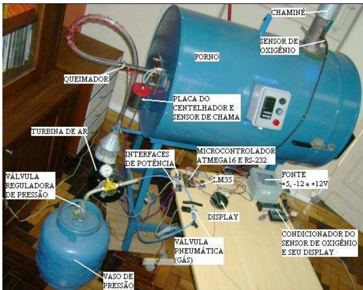
Figura 3.1: Implementação experimental do sistema de instrumentação e controle do forno.
