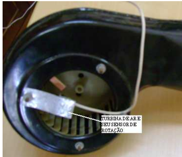
Figura 3.5: Foto da turbina de ar do fabricante Motorcraft utilizada no experimento.
