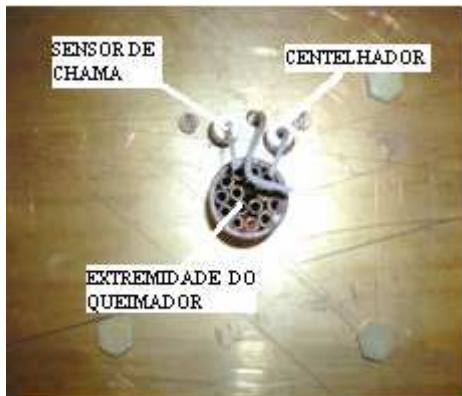
a) Extremidade do queimador com os tubos inseridos paralelamente; eletrodos do sensor de chama e do centelhador.
