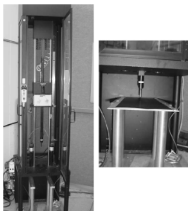
Figura 3.5 - Equipamento de Impacto Instron – Dunatup 8250 e detalhes da ponta do impactador. (MAL et al., 2005)
