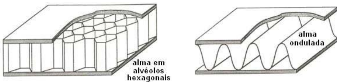
Figura 2.8 - Representação de compostos sanduíches com almas vazias (BERTHELOT, 1992).
