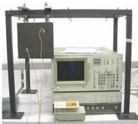
Figura 4.5 - Analisador de Impedância HP 4194A e sistema de fixação dos corpos de prova.
