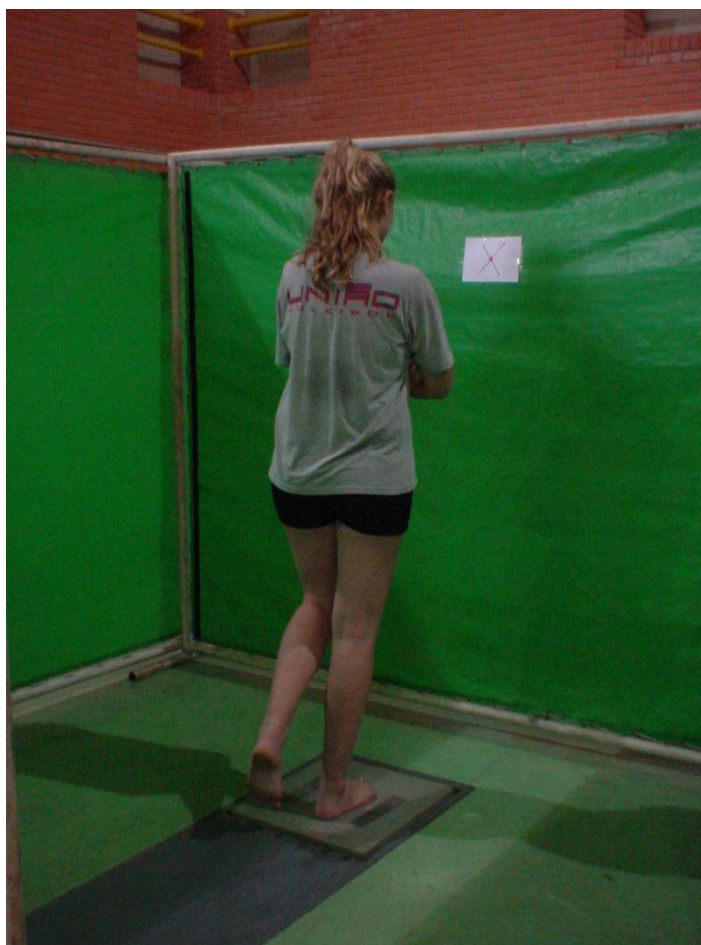
Figura 14 – Atleta em apoio unipodal sobre a plataforma de força. Pode-se observar o ponto fixo (onde a atleta está olhando) e as divisórias removíveis ao redor da atleta.
