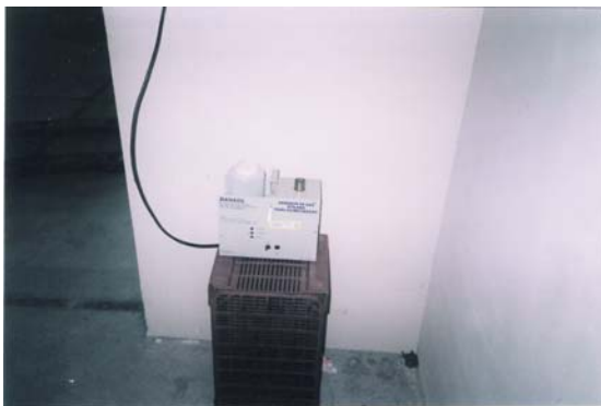
Figura 16 – Vaporizador de gás etílico em estufa
