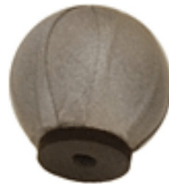
Figura 4.4 - Marcador esférico recoberto por fita retro-flexível à luz infravermelha. A imagem deste marcador foi feita por uma câmera insensível à luz infravermelha.
