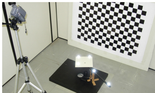
Figura 5.2 - Dispositivo usado para estimação da precisão e exatidão do sistema em escala maior. Ao fundo verifica-se o objeto de calibração de dimensões 1,1x0,9 metros.
