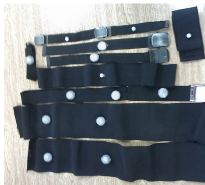
Figura 4.5 - Marcadores fixados à elásticos que irão envolver os principais membros do corpo.
