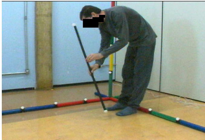
Figura 5.3 - Teste da barra rígida usado para estimar a precisão e exatidão de um sistema de captura de movimento 3D. Os dois marcadores fixados às extremidades da barra terão suas coordenadas reconstruídas e a variação do valor da distância entre eles é estudada para estimar os valores de precisão e exatidão do sistema.
