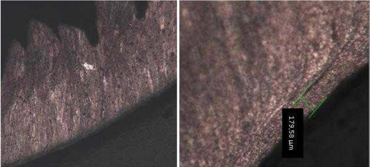
Figura I.8 – Micrografias da amostra de cavaco do teste 12, utilizando as seguintes condições:  $V_c = 130$  m/min e  $VB = 0,5$  mm, utilizando aumentos de 100X e 400X, respectivamente
