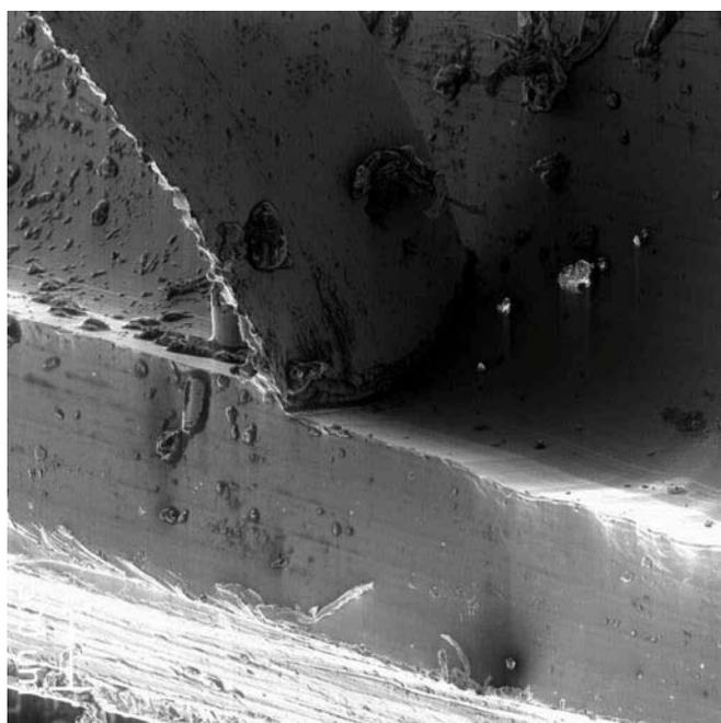
Figura 4.6 – Amostra da raiz do cavaco para  $VB = 0$  mm;  $V_c = 150$  m/min (20 X)
