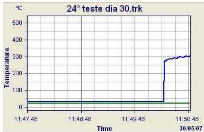
Figura II.24. Sinal de temperatura do cavaco durante o 24º ensaio utilizando  $V_c = 160$  m/min e  $VB = 0,4$  mm
