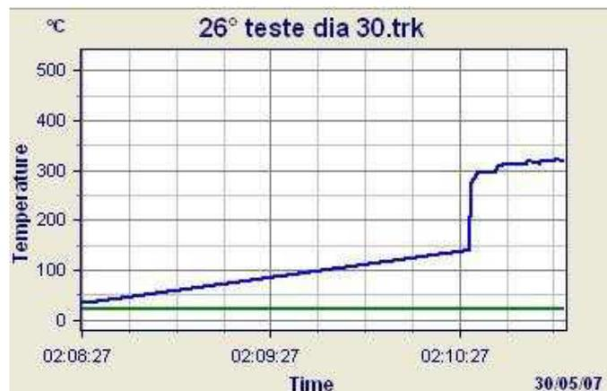
Figura II.26. Sinal de temperatura do cavaco durante o 26º ensaio utilizando  $V_c = 120$  m/min e  $VB = 0,5$  mm
