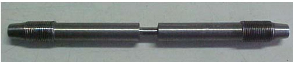
Figura 5.5 - Corpo de prova de diâmetro central de 5 mm
