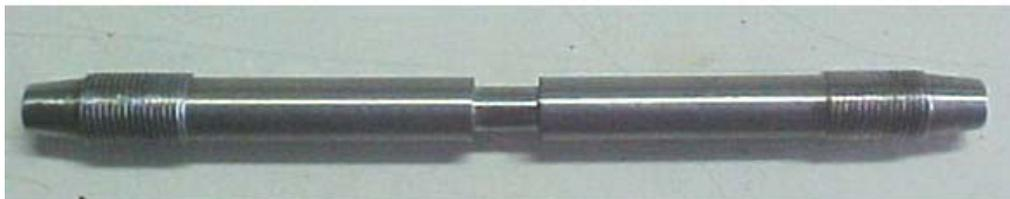
Figura 5.4 - Corpo de prova de diâmetro central de 7 mm
