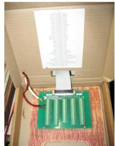
Figura 3.9 - Placa de aquisição e adaptador
