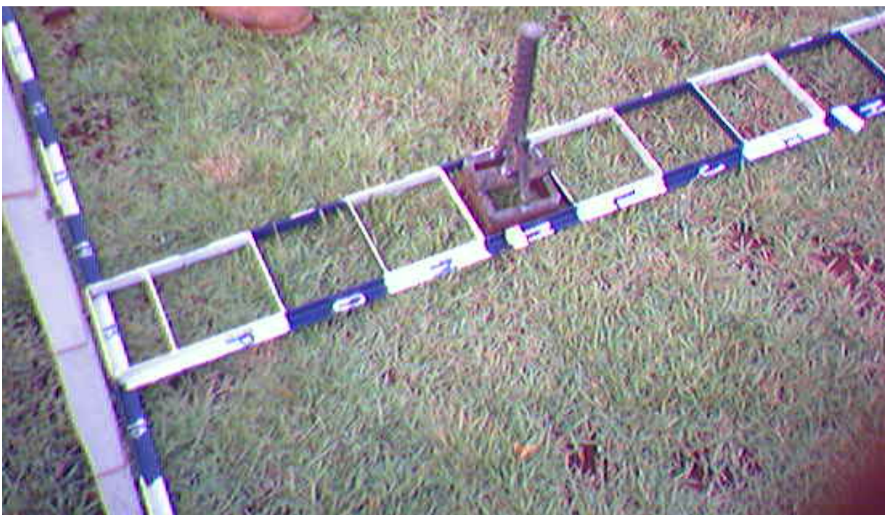
Figura 3 – Detalhe do gabarito e extrator.
