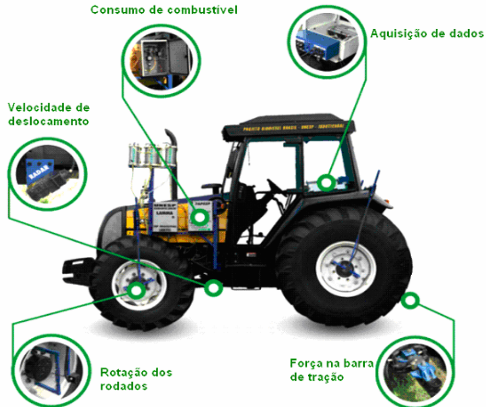
Figura 2. Trator utilizado no experimento com detalhamento da instrumentação embarcada para medição das variáveis de desempenho
