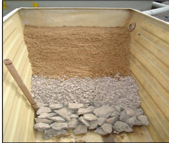
Figura 8. Visão estratificada montagem dos leitos cultivados.
