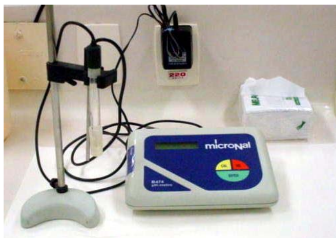
Figura 26 – Tipos de potenciômetros utilizados em centros de equivalência farmacêutica e laboratórios analíticos em medicamentos
