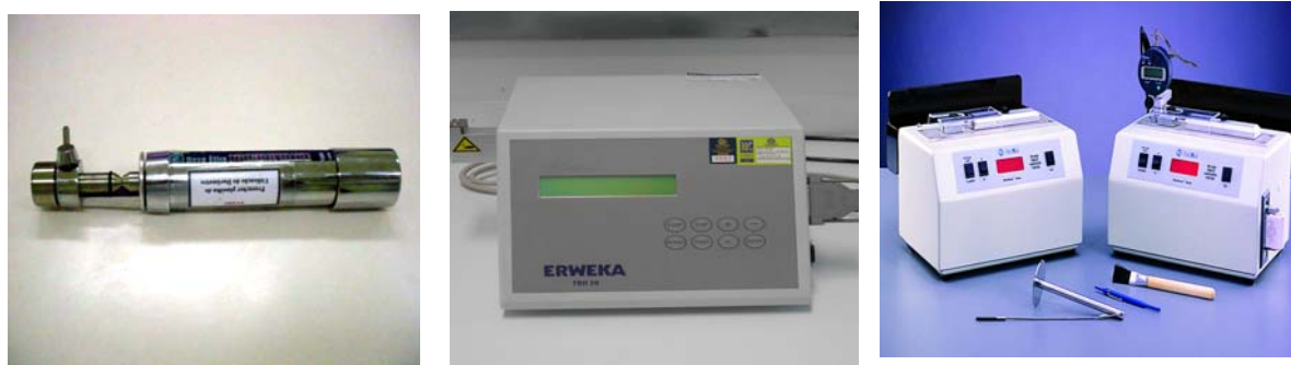
Figura 22 – Tipos de durômetros utilizados em centros de equivalência farmacêutica e laboratórios analíticos em medicamentos
