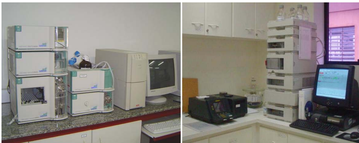
Figura 19 – Tipos de cromatógrafos em fase líquida utilizados em centros de equivalência farmacêutica e laboratórios analíticos em medicamentos
