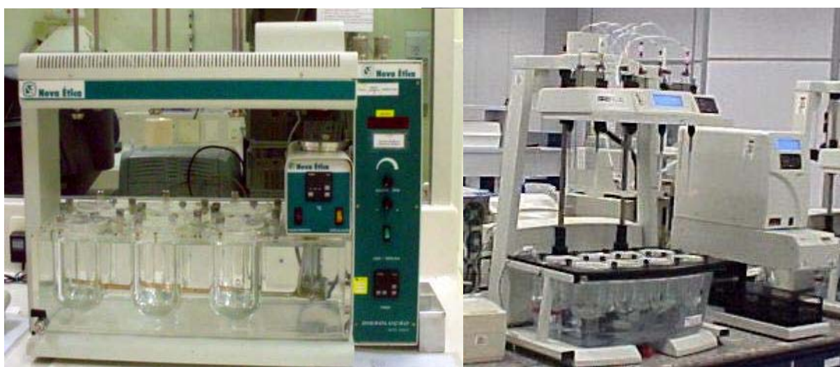
Figura 21 – Tipos de dissolutores utilizados em centros de equivalência farmacêutica e laboratórios analíticos em medicamentos
