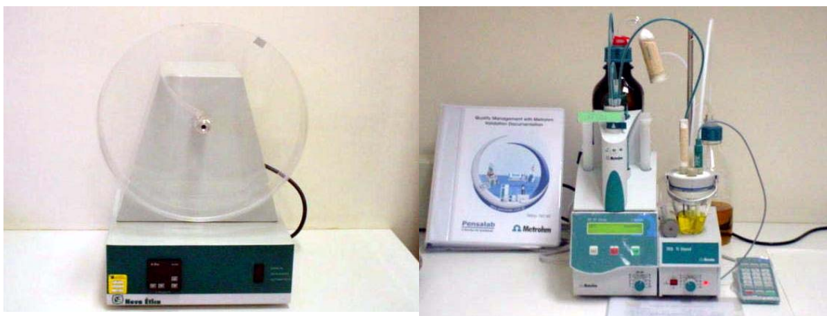
Figura 24 – Tipos de friabilômetro e Karl Fischer utilizados em centros de equivalência farmacêutica e laboratórios analíticos em medicamentos
