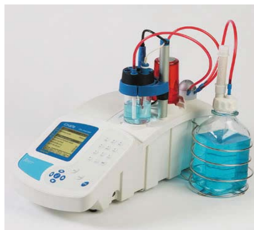
Figura 26 – Tipos de potenciômetros utilizados em centros de equivalência farmacêutica e laboratórios analíticos em medicamentos
