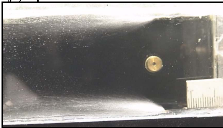
Figura F9-Injeção de líquido feita por 2 orifícios (1 e 3) com V = 59 m/s e Q = 0,3 l/min
