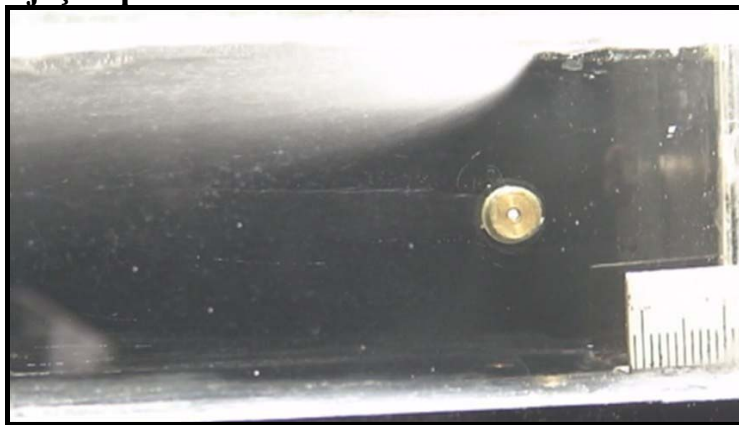
Figura F5-Injeção de líquido feita pelo orifício superior (1) com V = 74 m/s e Q = 0,3 l/min
