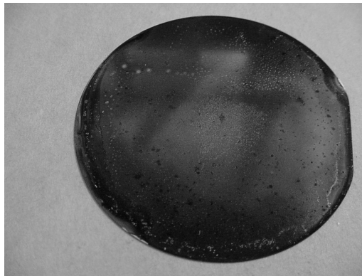
Figura 1 – Imagem do substrato Si <100> tipo-p 0,017 \Omega cm após o ataque por vapores químicos, face porosa.
