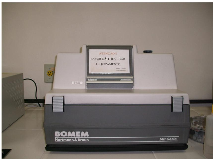
Figura 3.9: Espectrômetro Bomem MB Série 100, utilizado para obtenção dos espectros de infravermelho.
