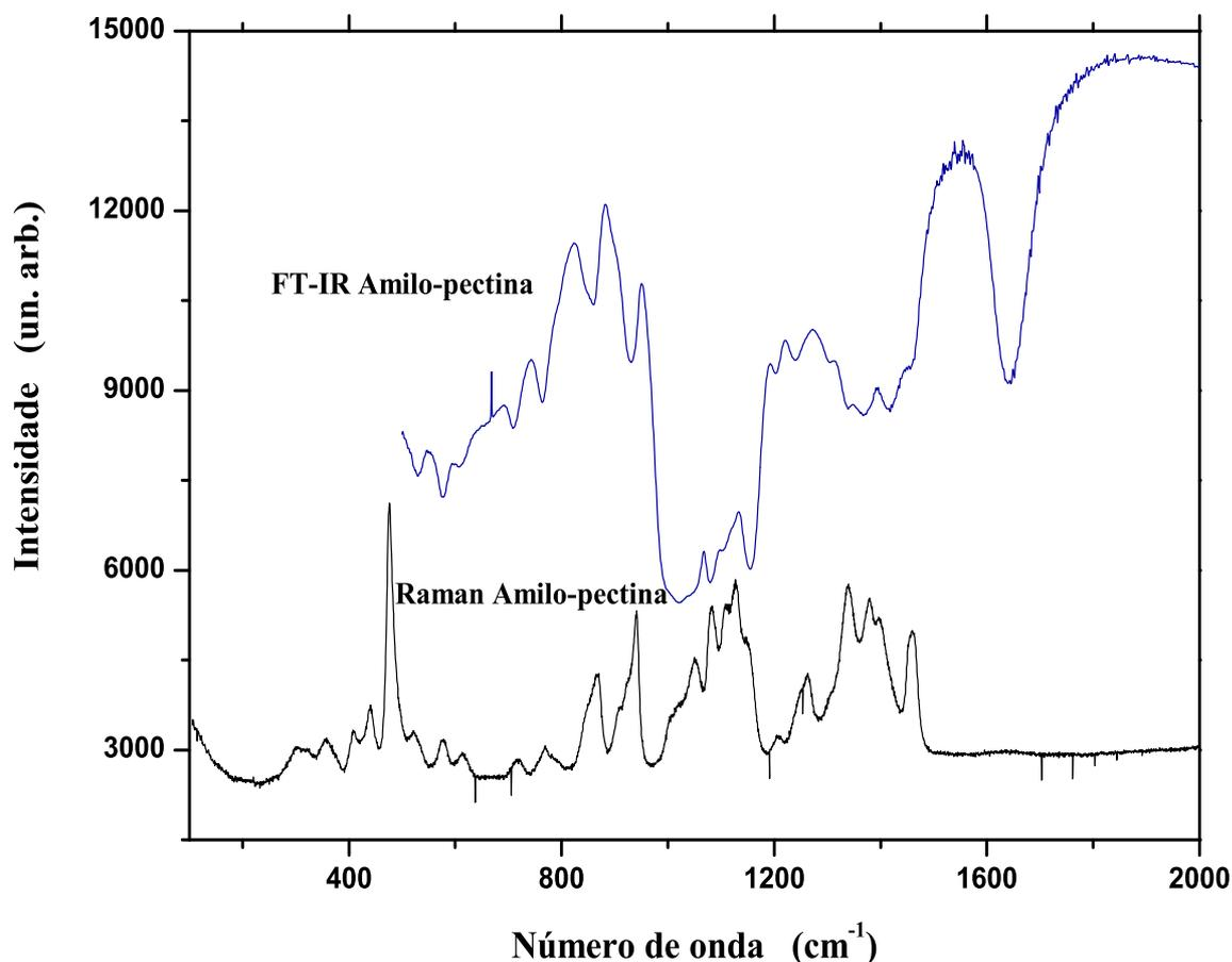
Figura 4.5: Espectros Raman e de infravermelho por transformada de Fourier da amilo-pectina.
