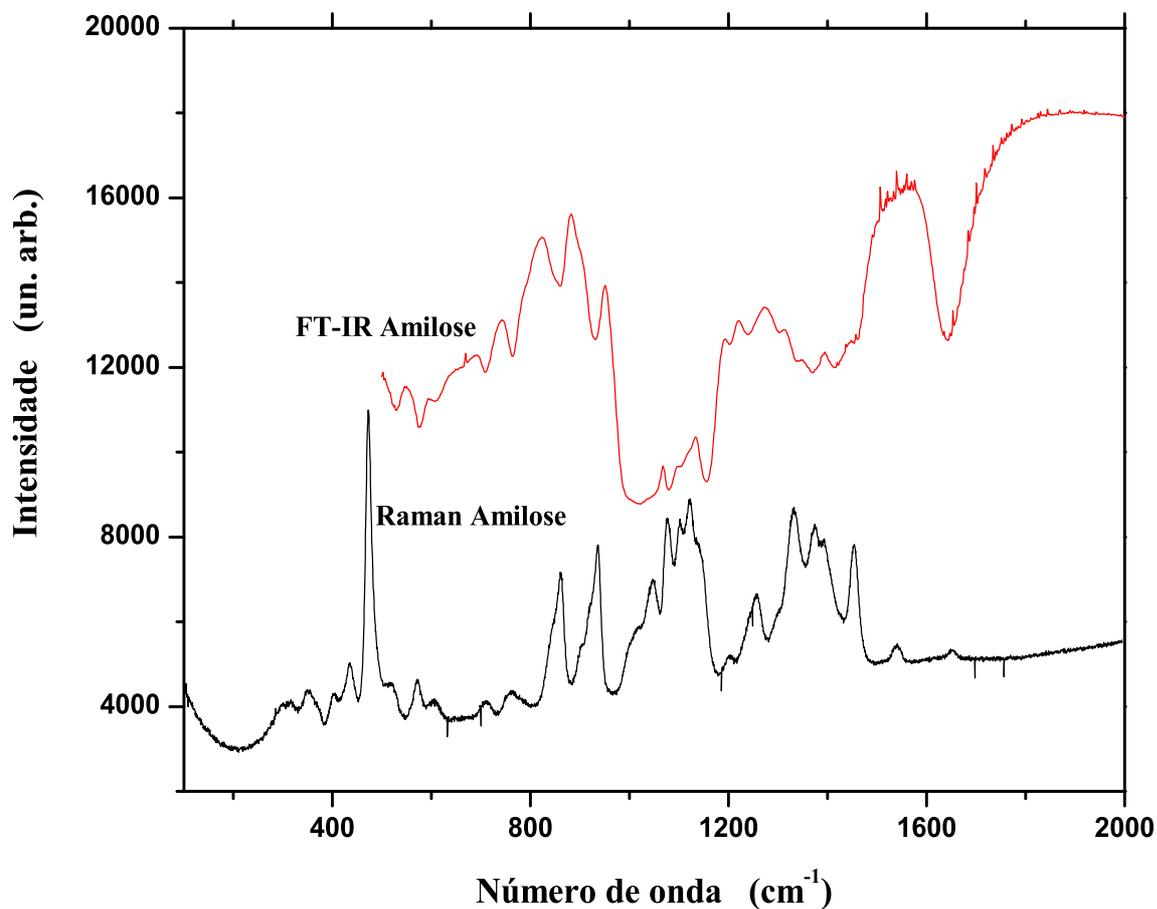
Figura 4.4: Espectros Raman e de infravermelho por transformada de Fourier da amilose.
