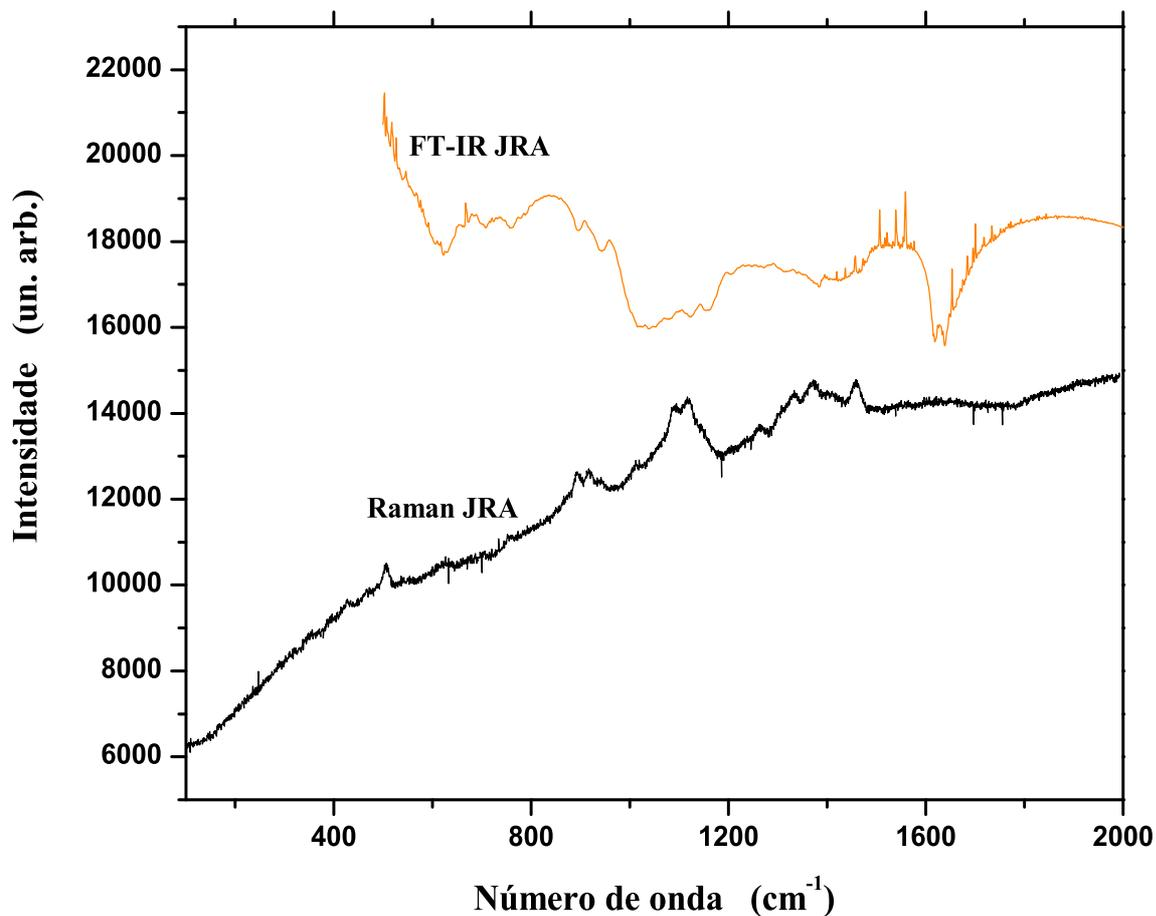
Figura 4.16: Espectros Raman e de infravermelho por transformada de Fourier da xiloglucana de jatobá, amostra JRA.
