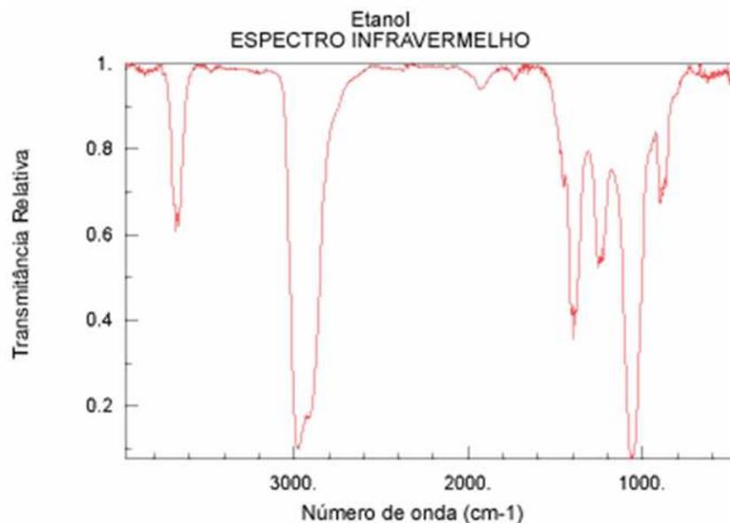
Figura 2.7: Espectro de infravermelho do etanol [13].
