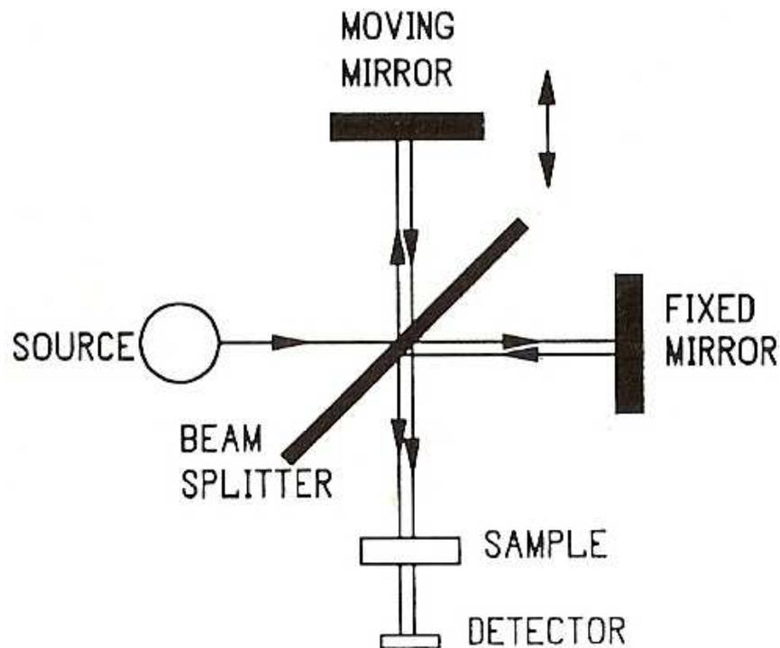
Figura 2.8: Esquema de um espectrômetro por transformada de Fourier [6].
