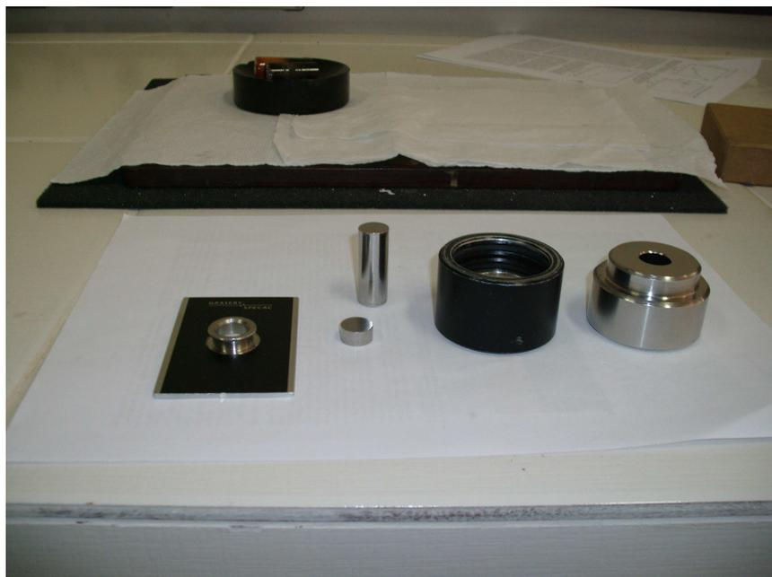
Figura 3.11: Equipamento utilizado para preparação das pastilhas.
