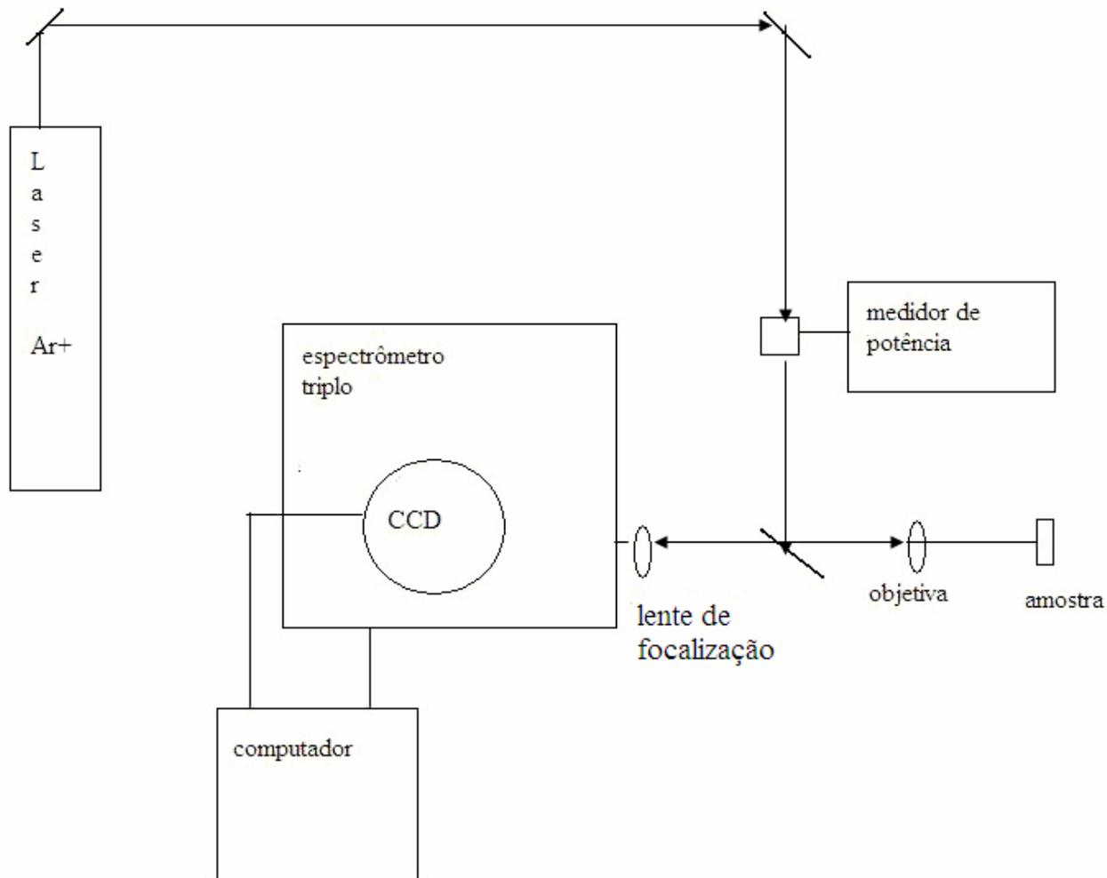
Figura 3.7: Esquema óptico do espectrômetro triplo.
