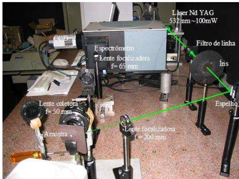
Figura 3.8: Montagem experimental utilizada para obtenção dos espectros de fluorescência.
