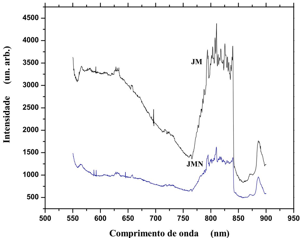
Figura 4.14: Espectro de fluorescência das xiloglucanas extraídas de jatobá-mirim, amostra JM e de jatobá, amostra JMN.
