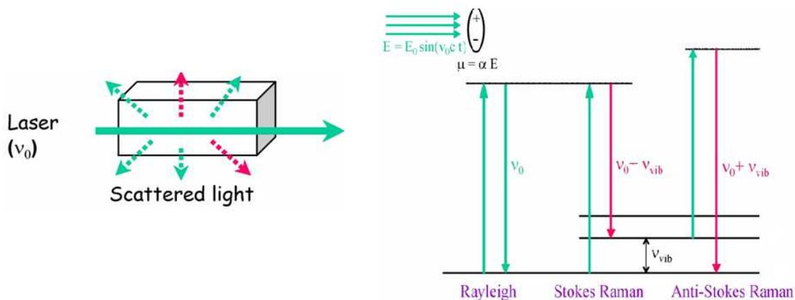
Figura 2.4: Diagrama de níveis de energia para o espalhamento Raman [13].
