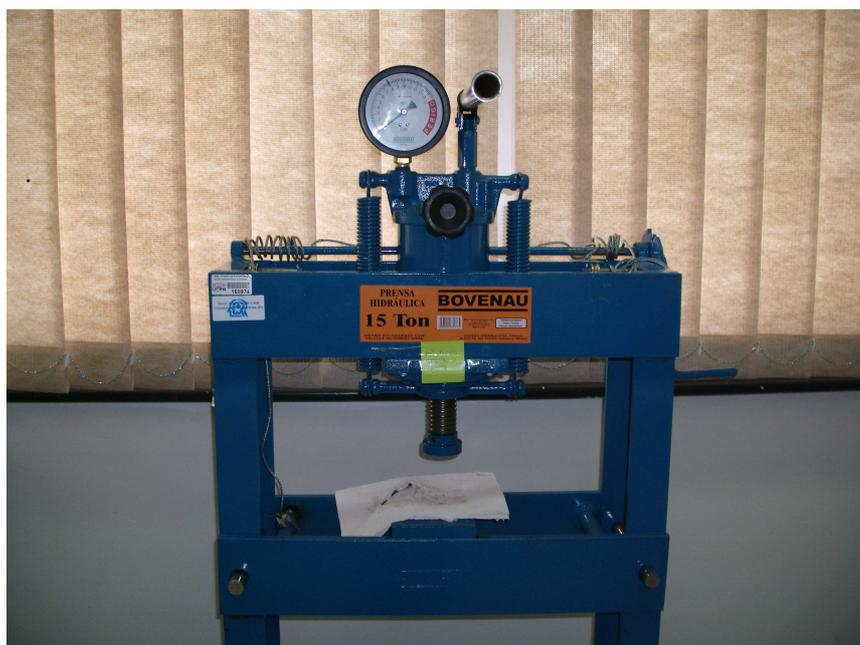
Figura 3.10: Prensa hidráulica utilizada para preparação das pastilhas.
