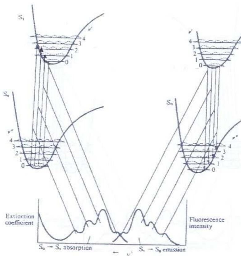
Figura 2.3: Processos de absorção e emissão entre os estados eletrônicos  $S_0$  e  $S_1$  de uma molécula orgânica [7].
