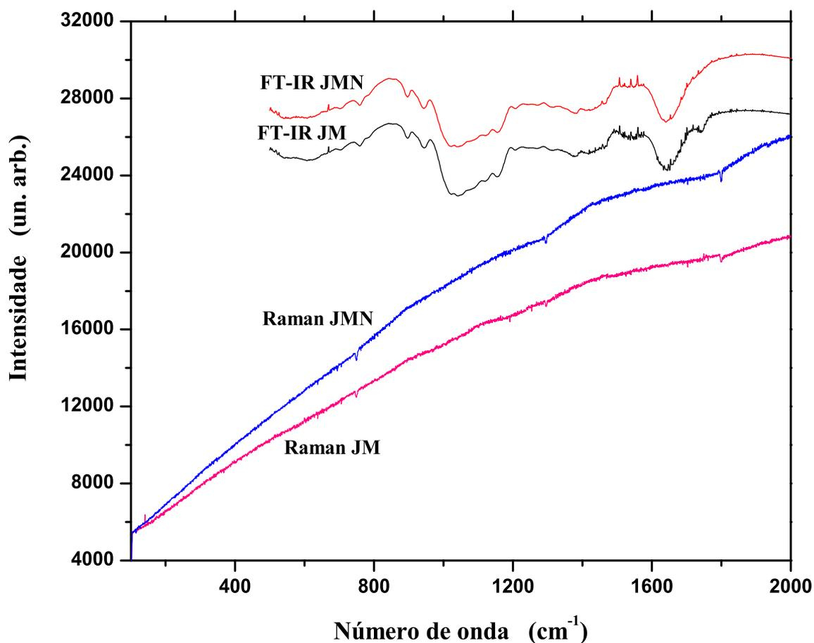
Figura 4.13: Espectros Raman e de infravermelho por transformada de Fourier das xiloglucanas extraídas de jatobá-mirim, amostra JM e de jatobá, amostra JMN.
