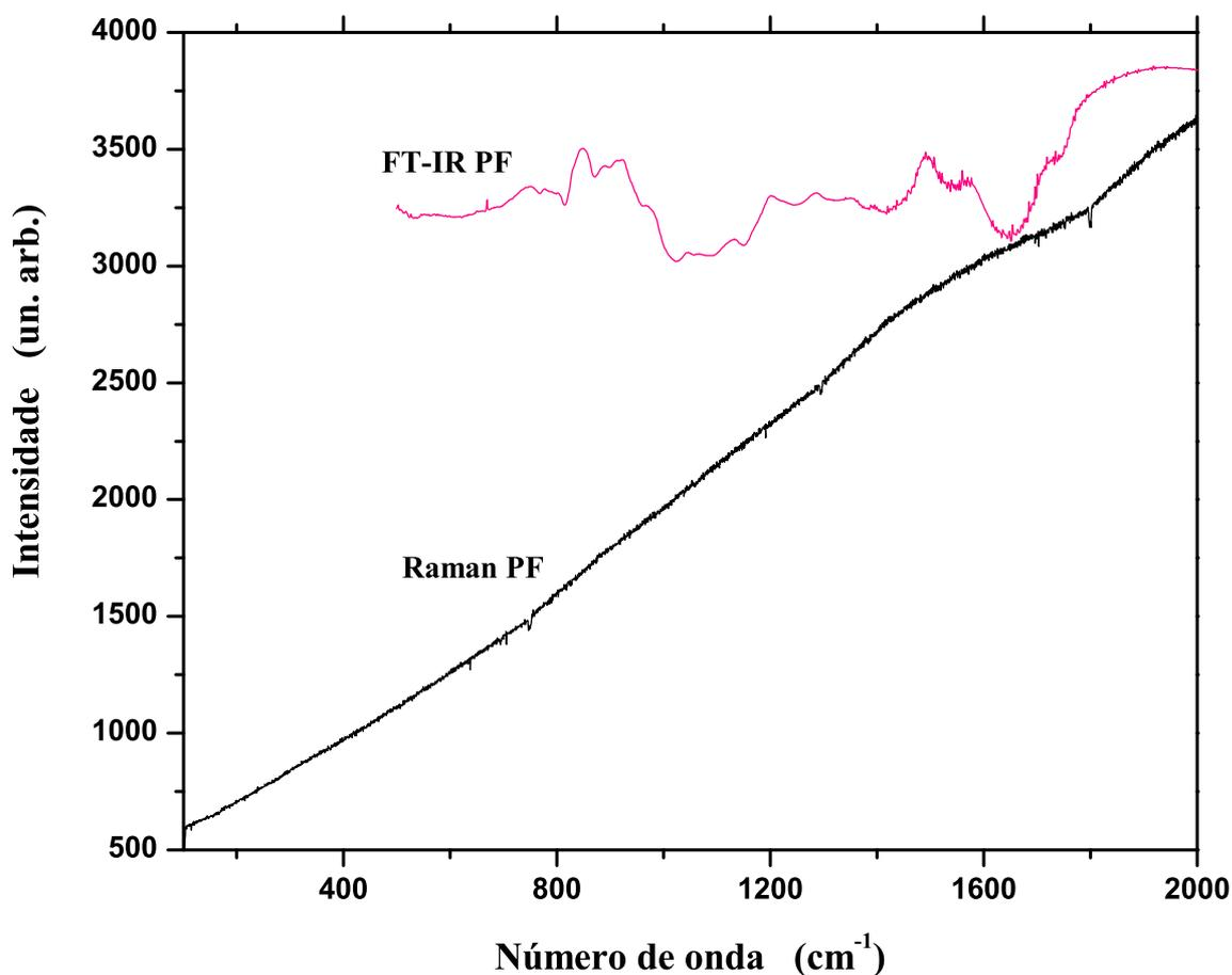
Figura 4.8: Espectros Raman e de infravermelho por transformada de Fourier da galactomanana de pau-ferro, amostra PF.
