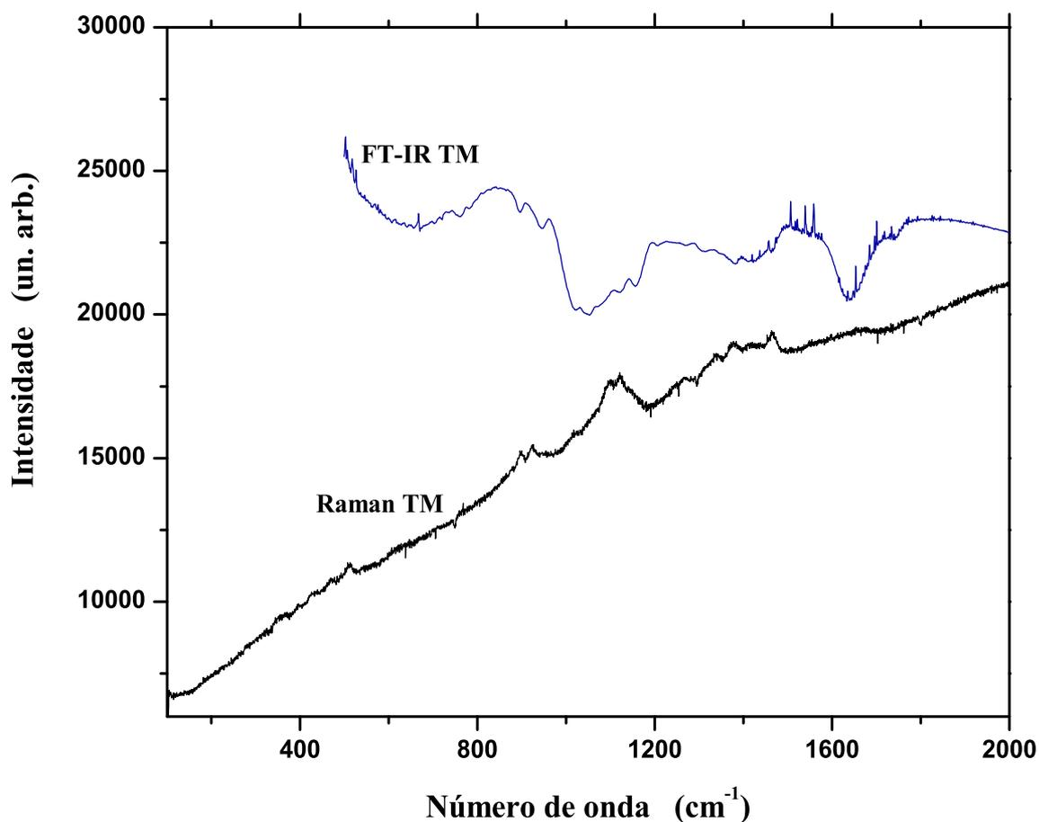
Figura 4.15: Espectros Raman e de infravermelho por transformada de Fourier da xiloglucana de tamarindo, amostra TM.
