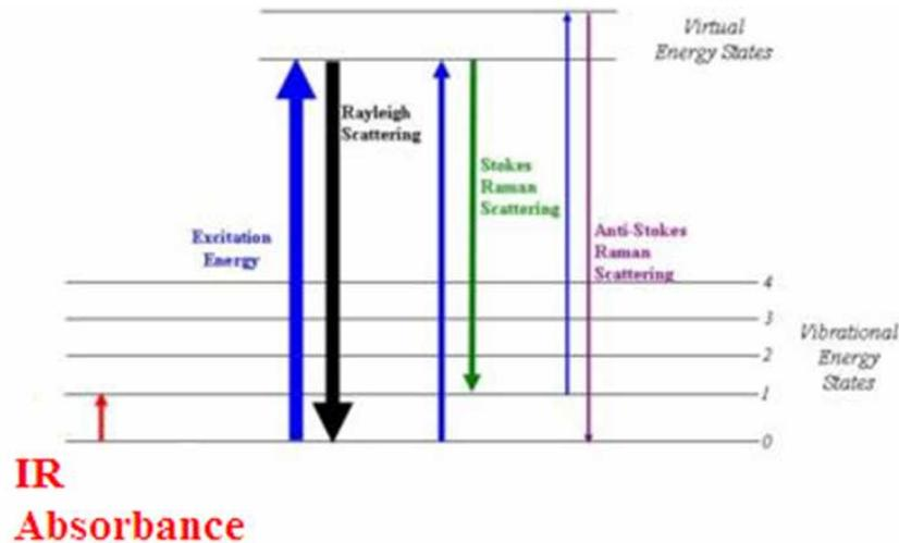
Figura 2.6: Diagrama de níveis de energia para o infravermelho [13].
