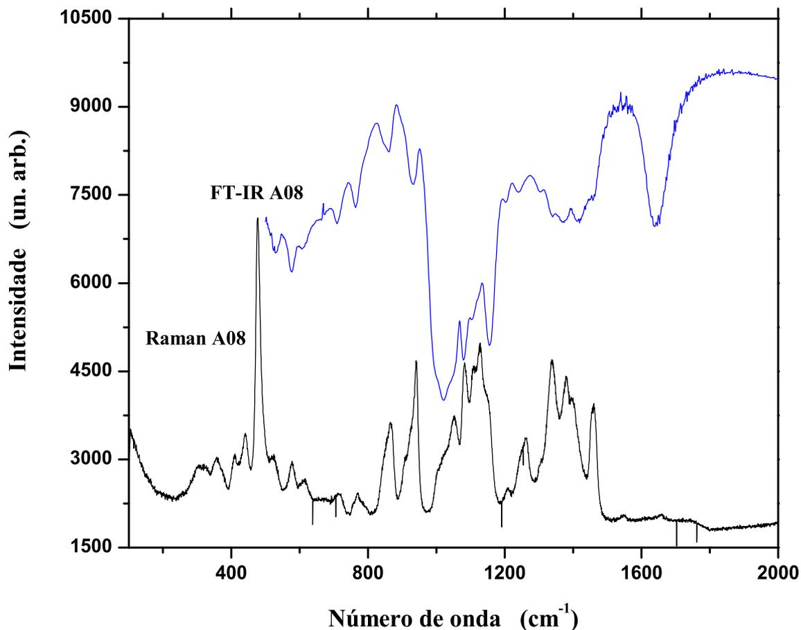
Figura 4.6: Espectros Raman e de infravermelho por transformada de Fourier do amido de milho, amostra A08.
