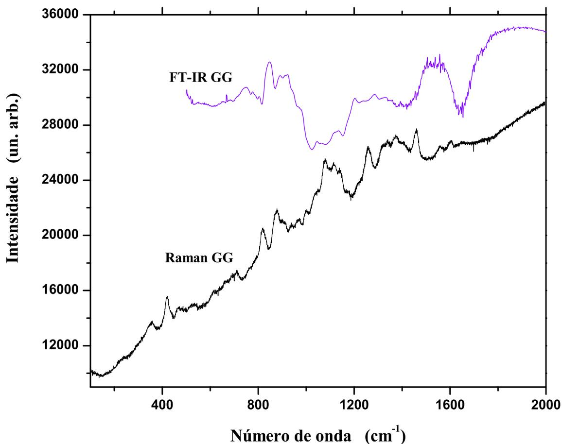
Figura 4.11: Espectros Raman e de infravermelho por transformada de Fourier da galactomanana de goma guar, amostra GG.
