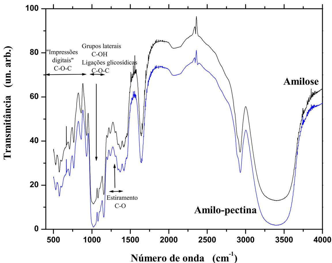
Figura 4.3: Espectro de infravermelho por transformada de Fourier da amilose e da amilo-pectina.
