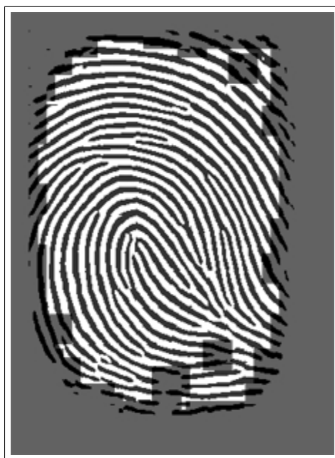
Figura 5.8: Imagem ID1 após realizar a segmentação.
