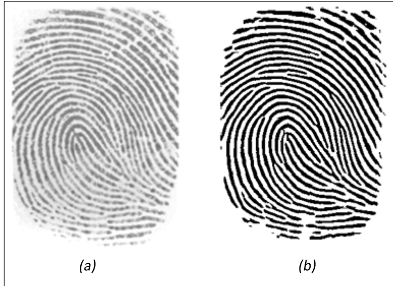
Figura 4.13: Exemplo da utilização do filtro de Gabor. Em (a), a imagem original e, em (b), a imagem filtrada.
