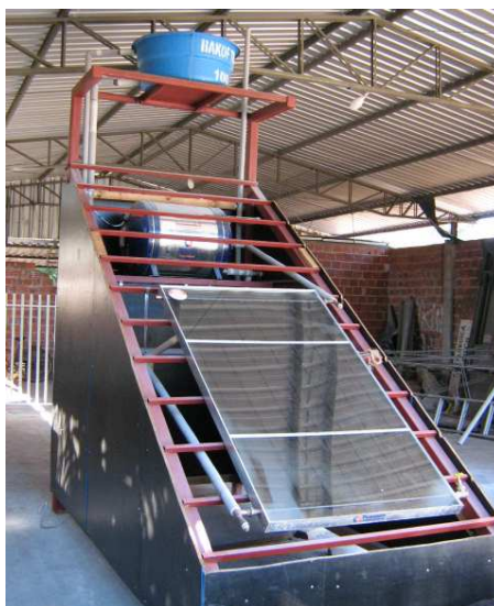
Figura 9 - Protótipo do sistema de aquecimento de água por energia solar, para funcionar por termossifão, antes da instalação.
