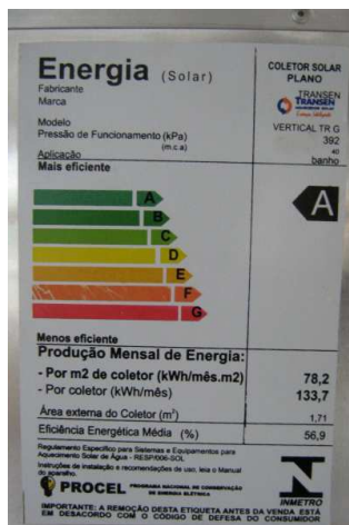
Figura 3 - Etiqueta PROCEL do coletor solar utilizado no protótipo.
