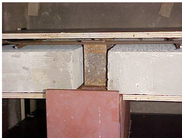
Figura 3.6 – Detalhes de fabricação dos modelos “ push out ” – mostrando fôrma, painéis, perfil, conector de cisalhamento e barras de armadura
