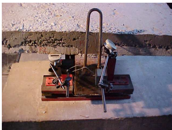
Figura 4.8 – Detalhe dos relógios comparadores (R1 e R2), fixados na extremidade da viga
