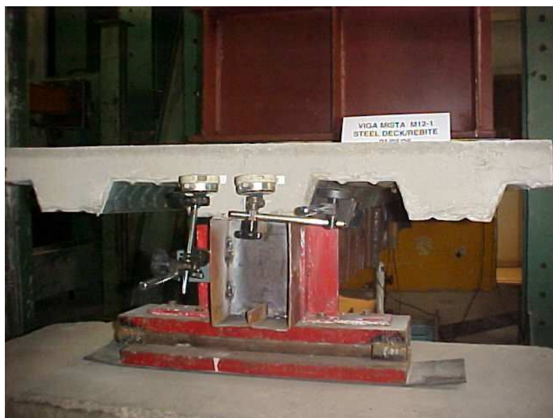
Figura 4.24 – Detalhe do enrijecedor de apoio do modelo VM-M12-1
