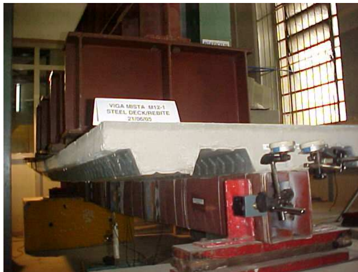
Figura 4.21 – Vista geral do ensaio do modelo VM-M12-1: notando-se a deformada do modelo, os relógios comparadores e o transdutor de deslocamento no meio do vão
