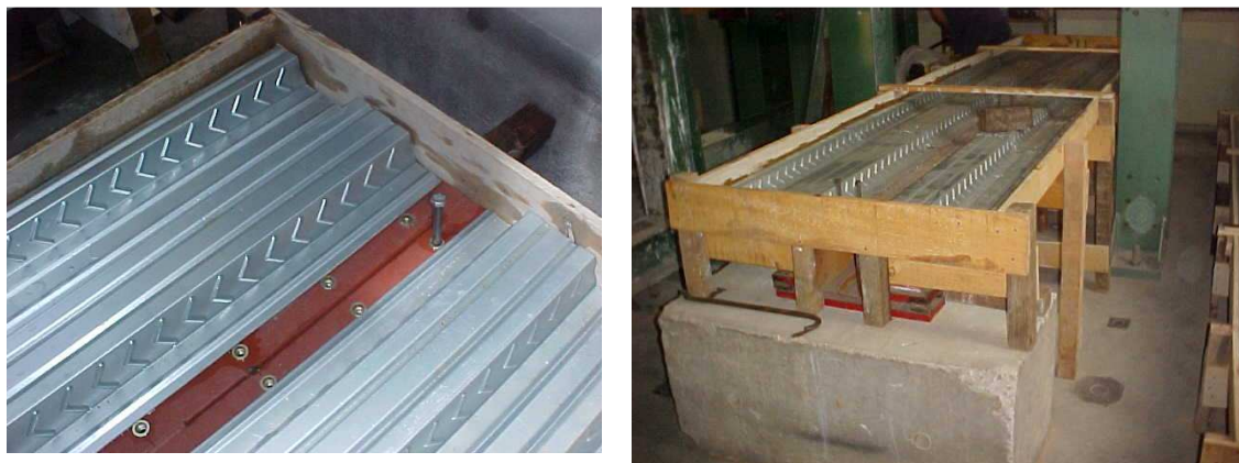
Figura 3.15 – Viga metálica e deck na fôrma
