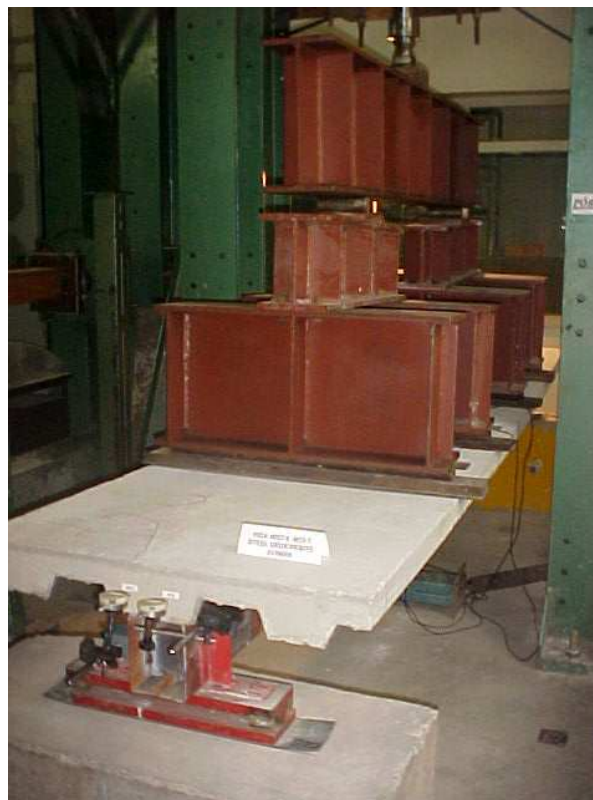
Figura 4.20 – Vista geral de um dos ensaios de viga mista
