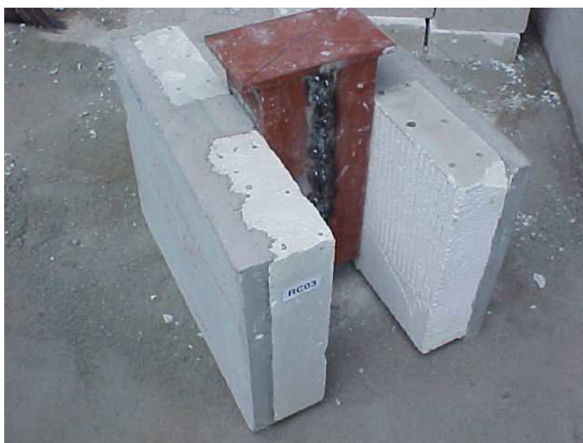
Figura 3.9 – Detalhes de fabricação dos modelos “push out”: modelo concretado
