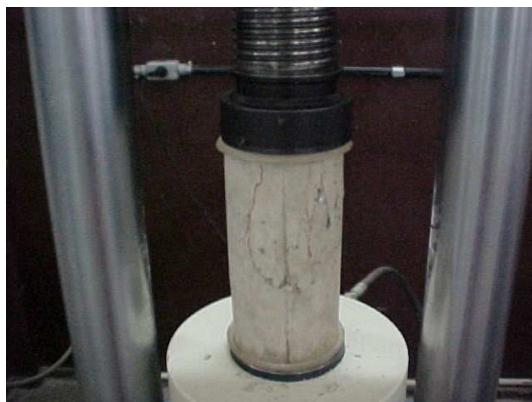
Figura 4.2 – Ensaio do corpo de prova cilíndrico de concreto para a determinação de sua resistência à compressão
