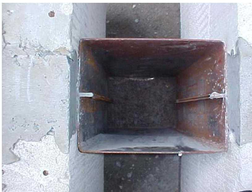
Figura 3.11 – Detalhes de fabricação dos modelos “ push out ” – vista inferior do perfil metálico
