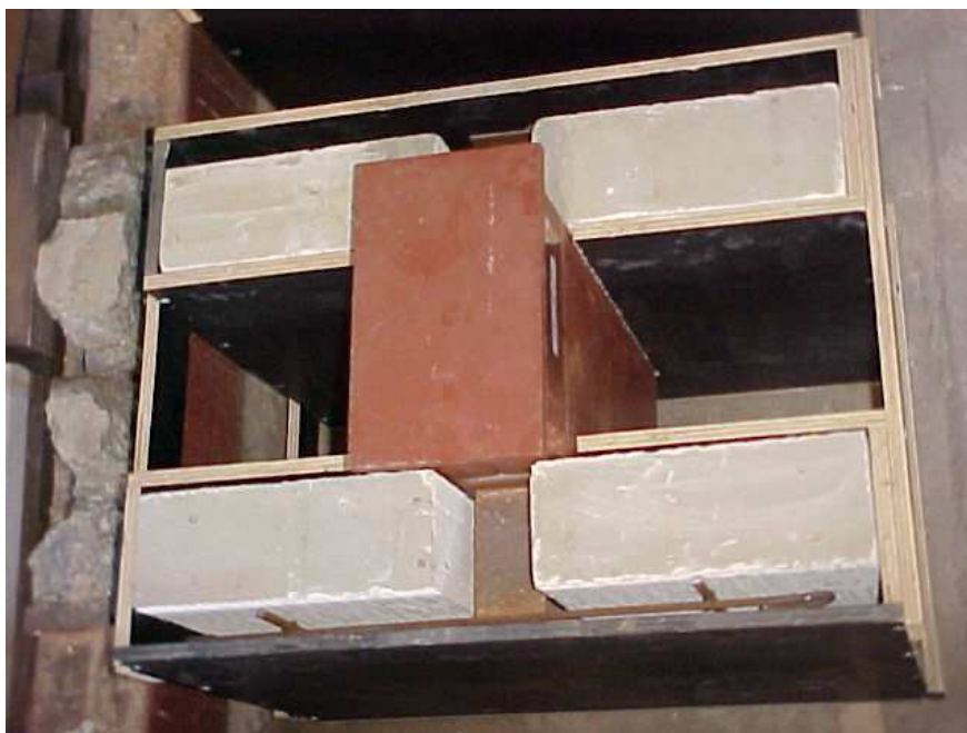
Figura 3.7 – Detalhes de fabricação dos modelos “ push out ” – mostrando fôrma, painéis, perfil, conector de cisalhamento e barras de armadura
