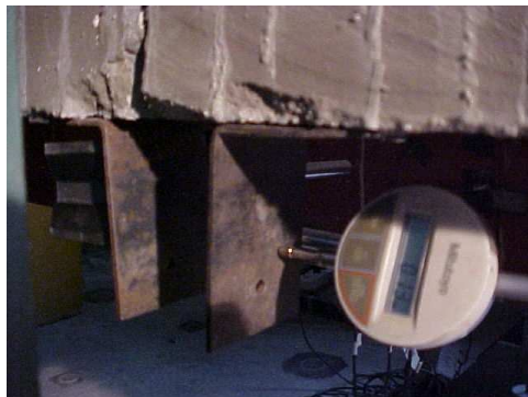
Figura 4.9 – Detalhe do relógio comparador (RC5)
