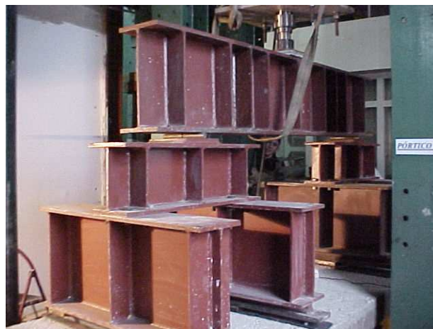
Figura 4.5 – Detalhe do sistema de aplicação de carga
