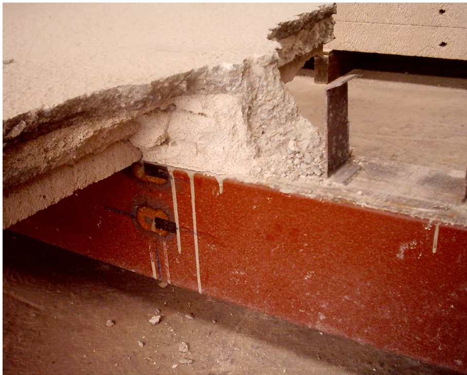
Figura B.2 – Detalhes do conector dos EER na viga do Tipo II
