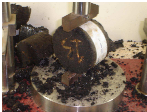
FIG. 3.14 Ensaio de Fadiga em andamento
