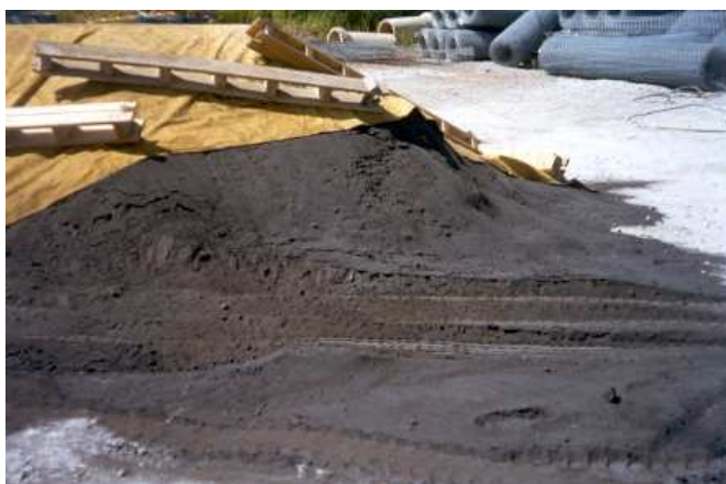
FIG. 2.3 Areia descartada de fundição – “Areia Verde” Fonte: BINA (2002)
