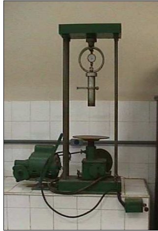
FIG. 3.12 Prensa utilizada para o ensaio de RT Fonte: CASTELO BRANCO (2004)
