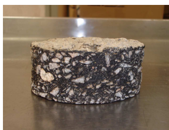
FIG. 4.31 Exemplo do Corpo-de-prova de PMF extraído da pista experimental um mês após a construção
