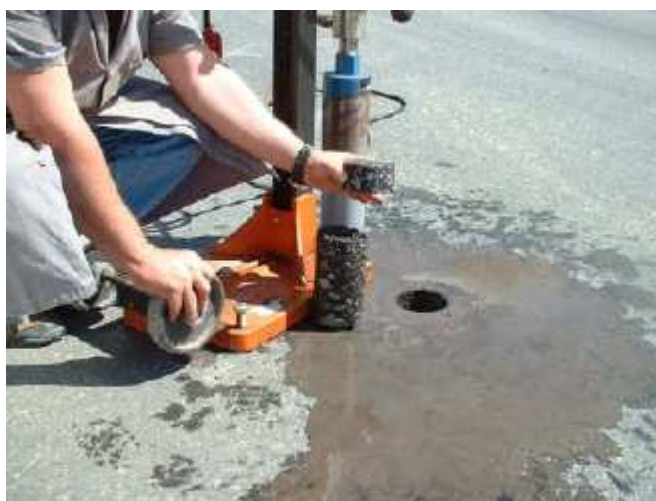
FIG. 4.29 Exemplo de extração dos corpos-de-prova da pista experimental
