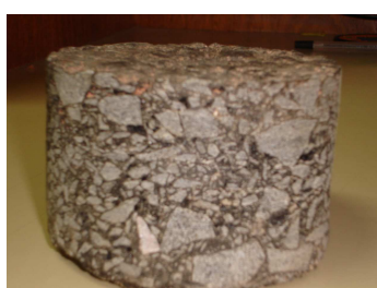
FIG. 4.30 Exemplo de Corpo-de-prova de CA extraído da pista experimental
