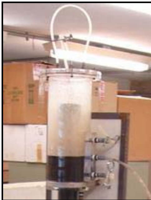
Figura 3.5 – Topo do reator (biogás armazenado no headspace e mangueira de saída do efluente).
