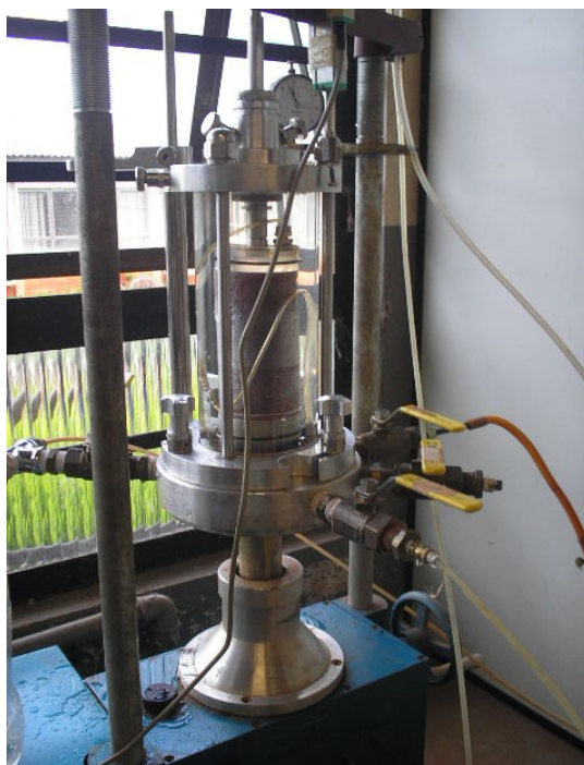
Figura 13 - Célula de compressão triaxial de solo.
