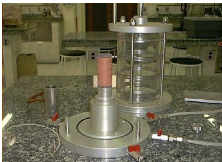
Figura 12 - Imagem da preparação do corpo-de-prova com uma pedra porosa em cada extremidade, antes da colocação da célula triaxial.
