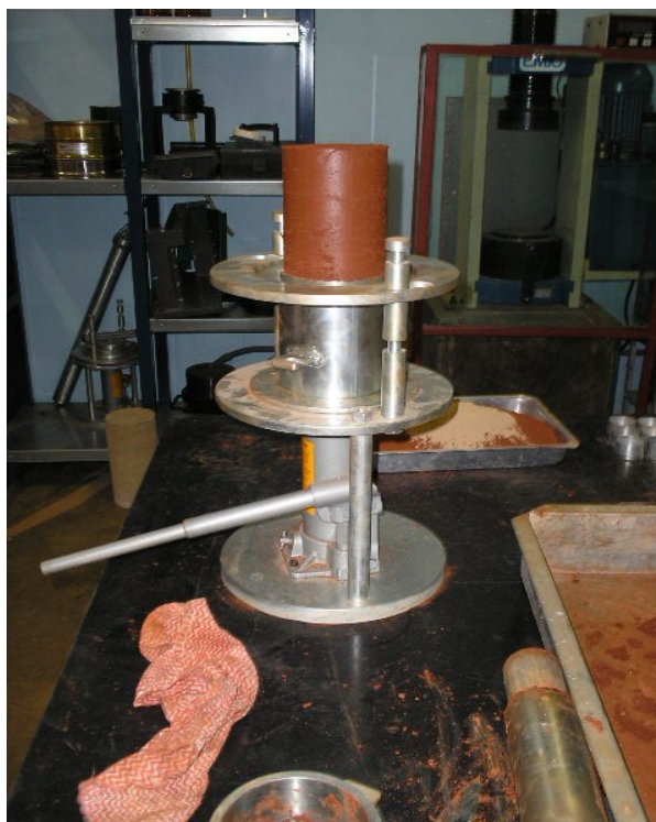
Figura 7 - Extração do corpo-de-prova do ensaio de Proctor.
