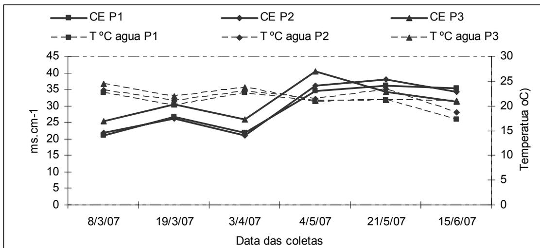
**Figura 14** - Variação da CE em função da temperatura durante o período de estudo.
