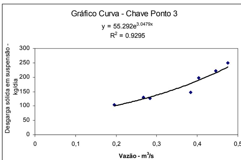
**Figura 35** - Curva chave descarga sólida *versus* vazão – ponto 3.
