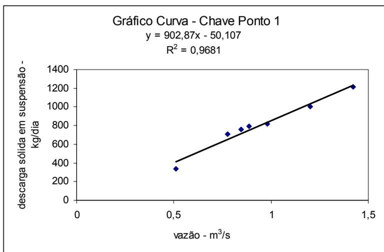
Figura 33 - Curva chave descarga sólida *versus* vazão – ponto 1.
