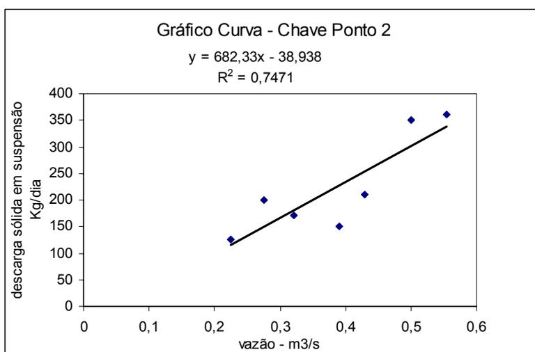
Figura 34 - Curva chave descarga sólida *versus* vazão – ponto 2.
