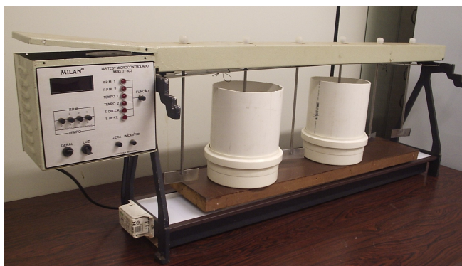
Figura 5 Reator anóxico adaptado ao Jar Test
