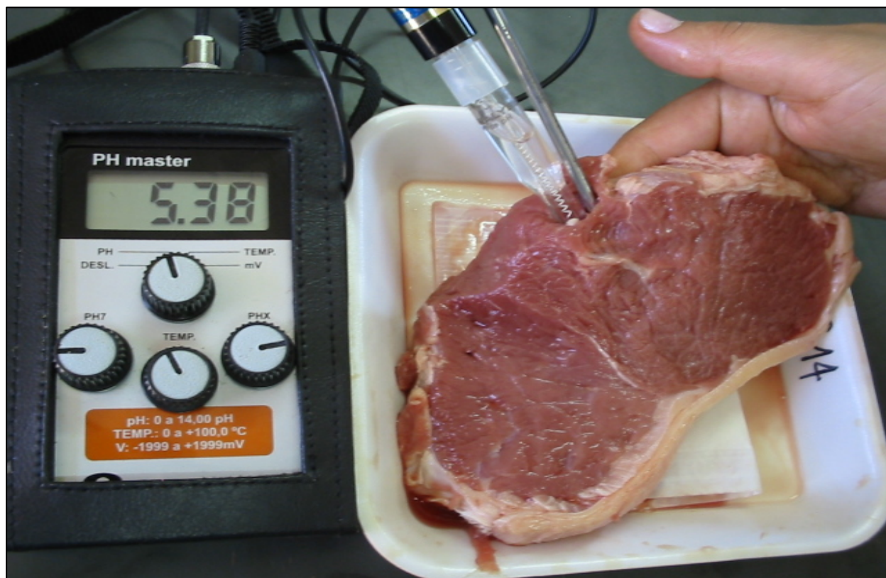
Figura 3 – Determinação do pH nas amostras.
