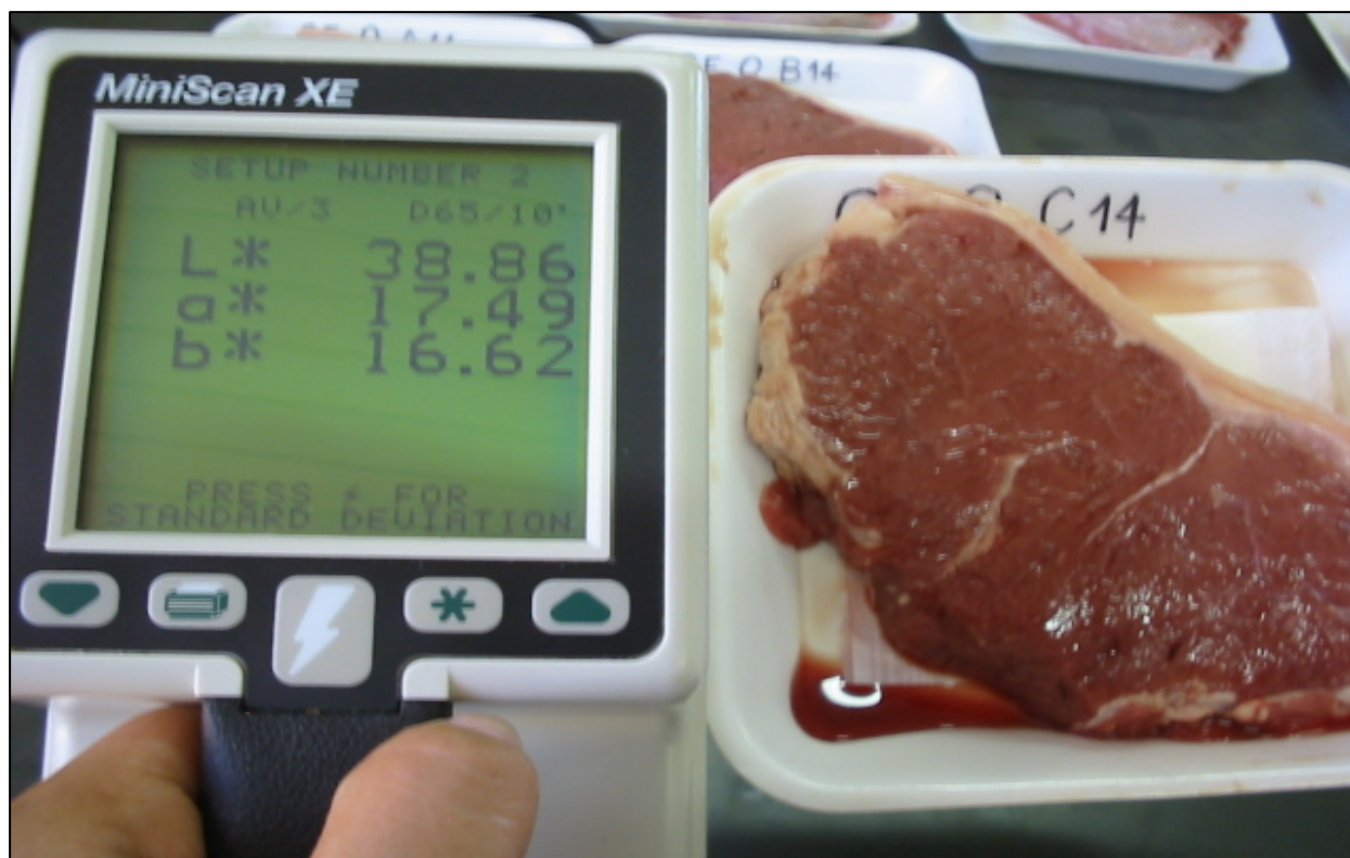
Figura 4 – Determinação da cor das amostras através de um colorímetro portátil
