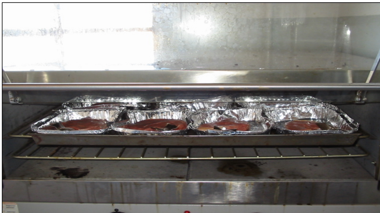
Figura 5 - Amostras colocadas em forno elétrico, à temperatura de 170°C.
