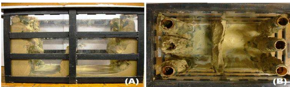
Figura 4.31: Cimentação ocorrida na C_E_10 - (A) Vista lateral e (B) Vista superior.
