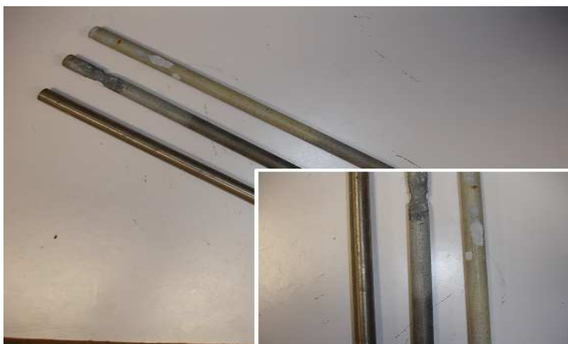
Figura 4.11: Aparência dos eletrodos de titânio corroídos em comparação a um eletrodo novo.
