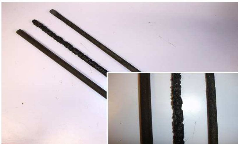
Figura 4.12: Aparência dos eletrodos de aço carbono corroídos em comparação a um eletrodo novo.
