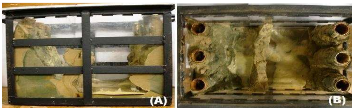
Figura 4.29: Cimentação ocorrida na C_E_09 - (A) Vista lateral e (B) Vista superior.
