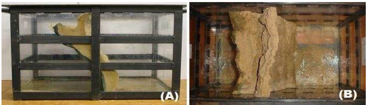
Figura 4.21: Cimentação ocorrida na C_E_05 - (A) Vista lateral e (B) Vista superior.
