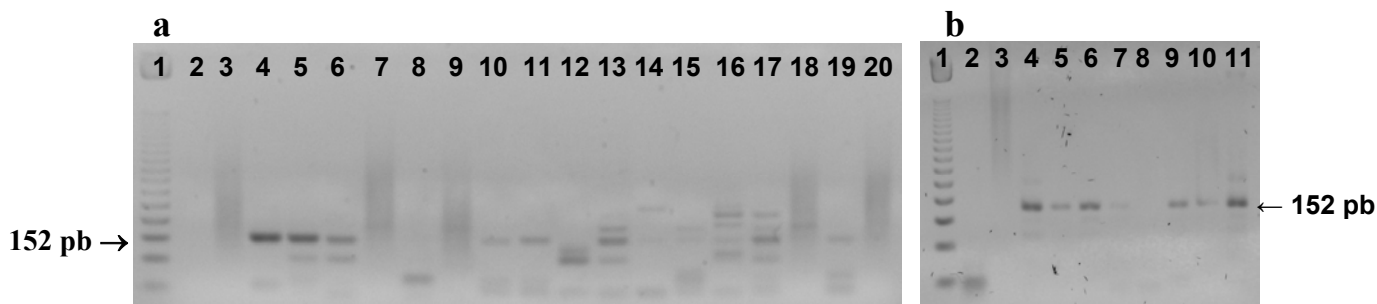
Figura 9 - Detecção do fragmento de 152 pb com os iniciadores CryIA-F/CryIA-R através da PCR.
