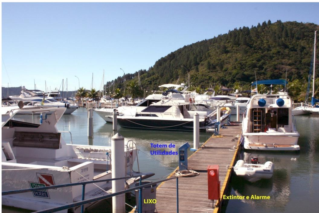
**Ilustração 62:** Pier Flutuante com totem de utilidades, sistema de alarmes e coleta de resíduos
