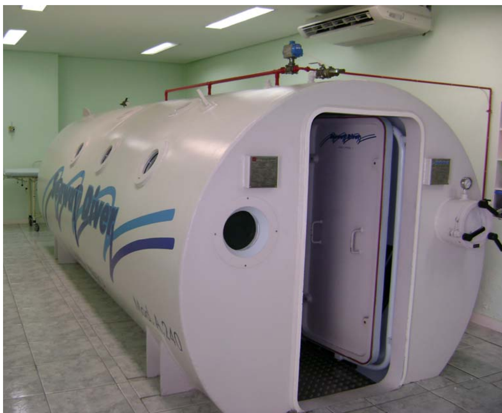
FIGURA 2- Câmara hiperbárica multiplace Seaway Diver. Volume total 16,60 m 3 . Peso vazio 9.500 Kg. Ano de fabricação 2000.
