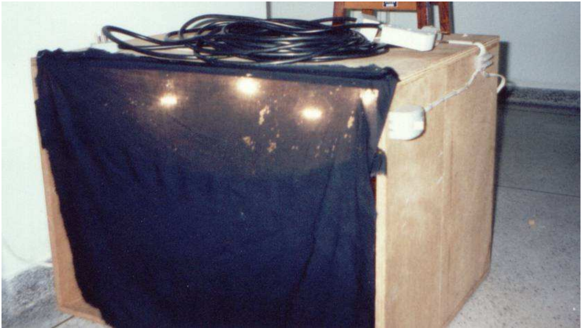
Fig. 5 - Caixa de luz, construída em madeira (52 x 62 x 53 cm), contendo três lâmpadas de 100W.
