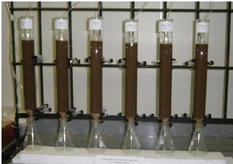
Figura 8 - Fotografia das colunas de percolação (Fonte: CORRÊA, 2005)
