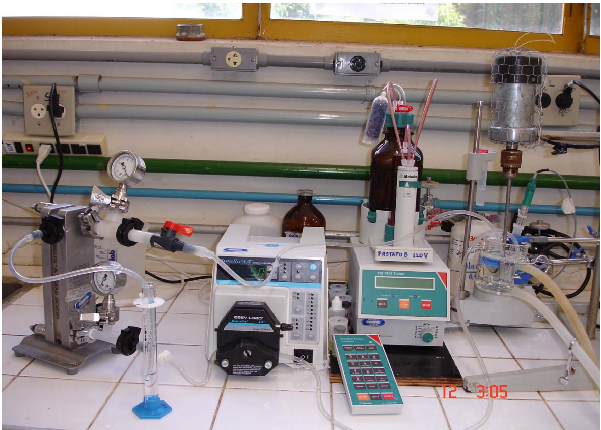
Figura 4.5: Foto do sistema REM (Reator + Membrana placa plana) para hidrólise com CPA.
