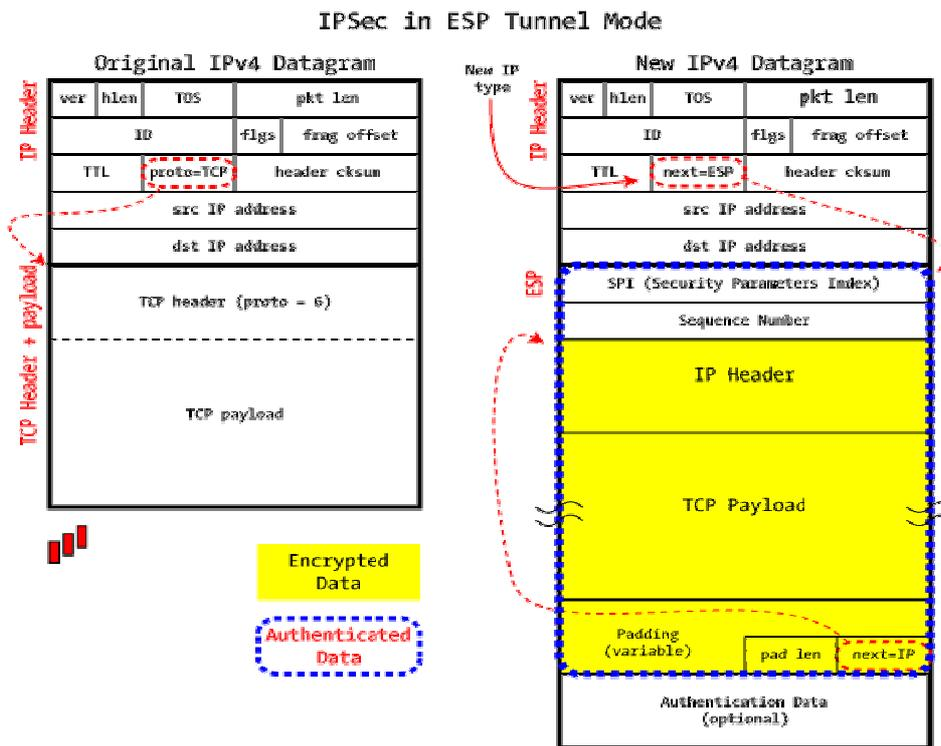
**Figura 18 – Modo túnel IPSec sobre ESP [59]**
