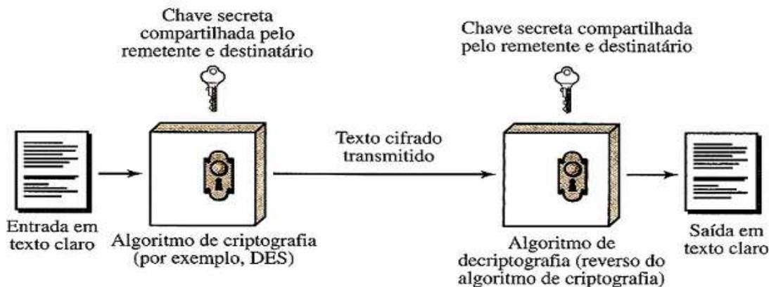
**Figura 4 – Modelo simplificado da criptografia convencional [58]**
