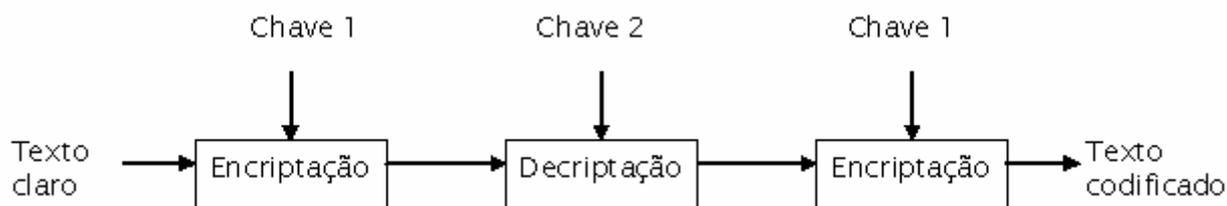
**Figura 6 - Ciframento utilizando 3DES**
