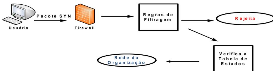
**Figura 8: Entrada do pacote SYN pelo *firewall* baseado em estado**
