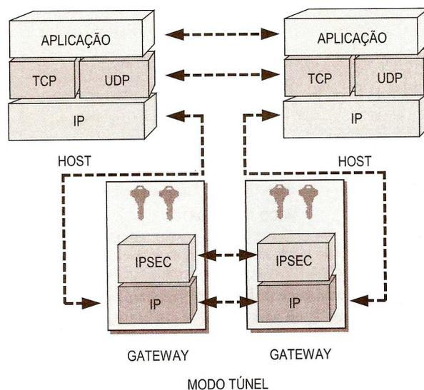
**Figura 17 – No modo ‘túnel’, o IPsec é implementado no gateway [40]**
