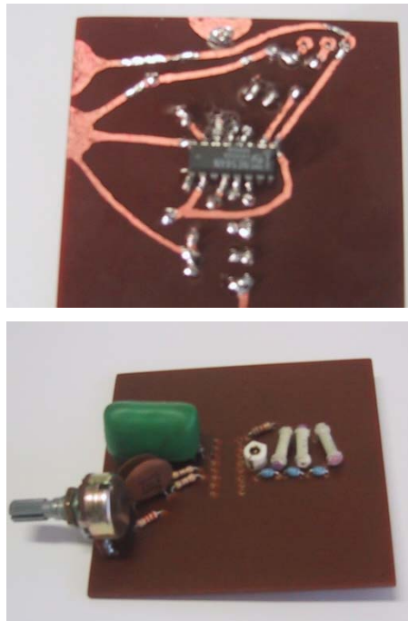
Figura 4.8 – Realização do circuito de demodulação de fase (no topo, destaca-se o CI, que está na superfície inferior da placa. Os demais componentes foram soldados na superfície superior da placa).
