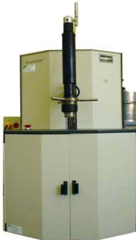
Figura F. 1 - Vista do POREMASTER, da QUANTACROME Instruments, Modelo 33.
