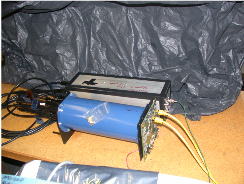
Figura 6.9: Caixa de LEDs, PMT box, FEB montados para os testes
