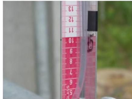
Figura 99 - Escoador de orifício circular durante a calibração no poço FAL-40.
