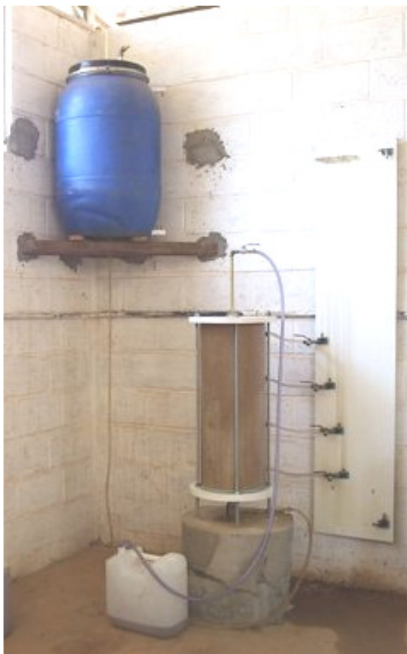
FIGURA 9 – Coleta de percolado durante a realização do ensaio de capacidade de campo.
