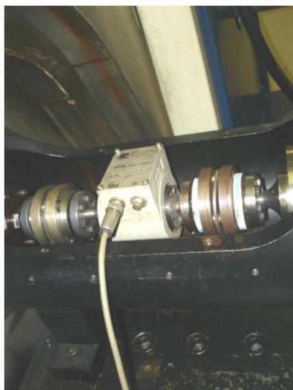
**Figura 30 - Célula de Torque**
