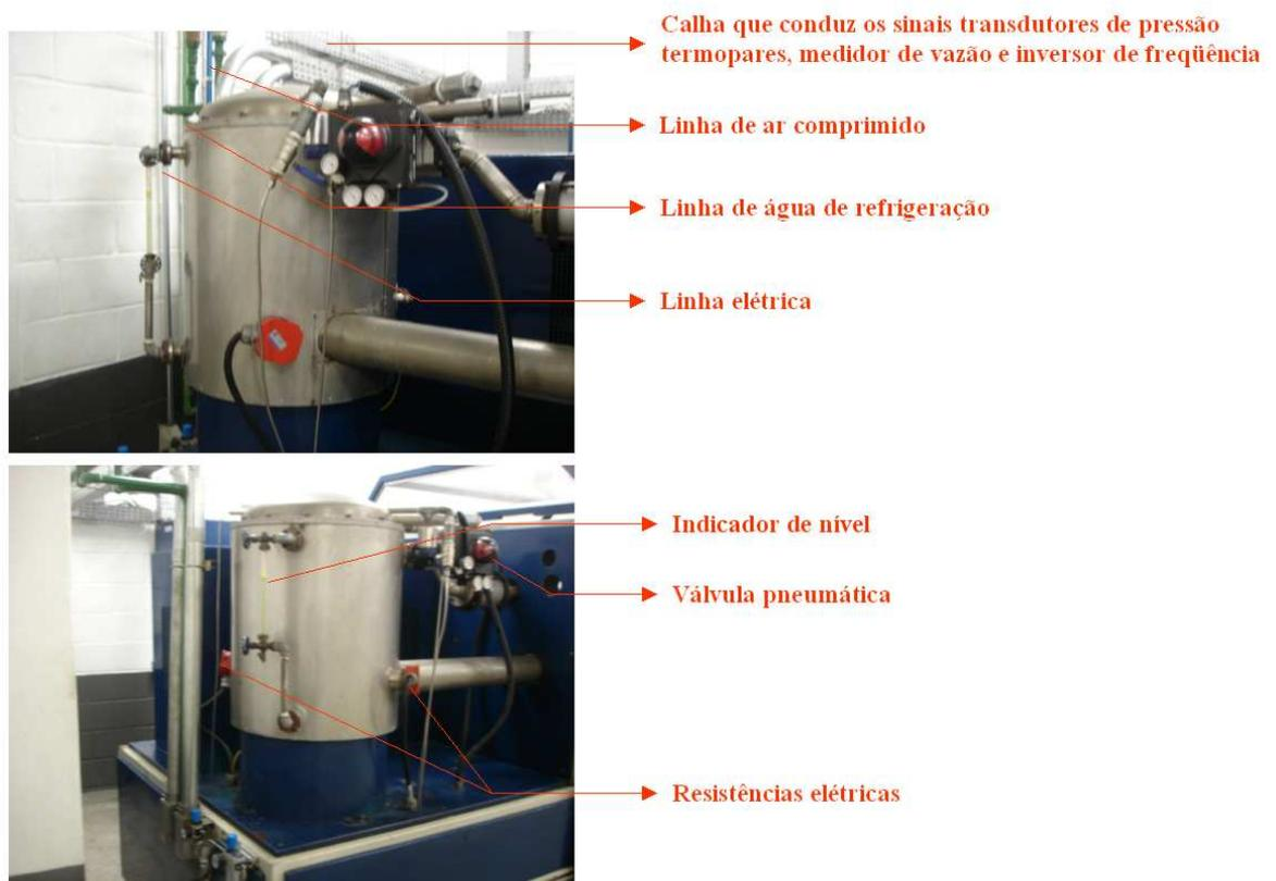
**Figura 25 - Reservatório, Válvula Proporcional, Resistências, e Linhas de Ar Comprimido e Água de Refrigeração.**
