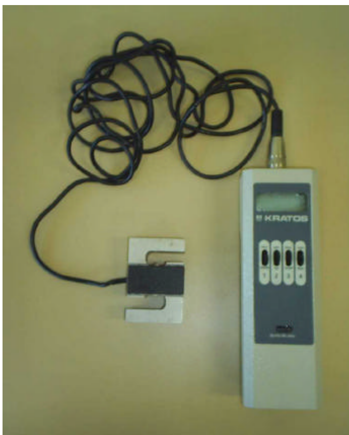
Figura 8 – Célula de carga utilizada para a coleta dos dados de força.
