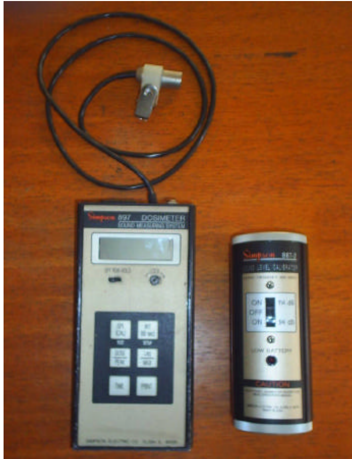
Figura 1 – Dosímetro de ruído de uso pessoal utilizado na coleta de dados.
