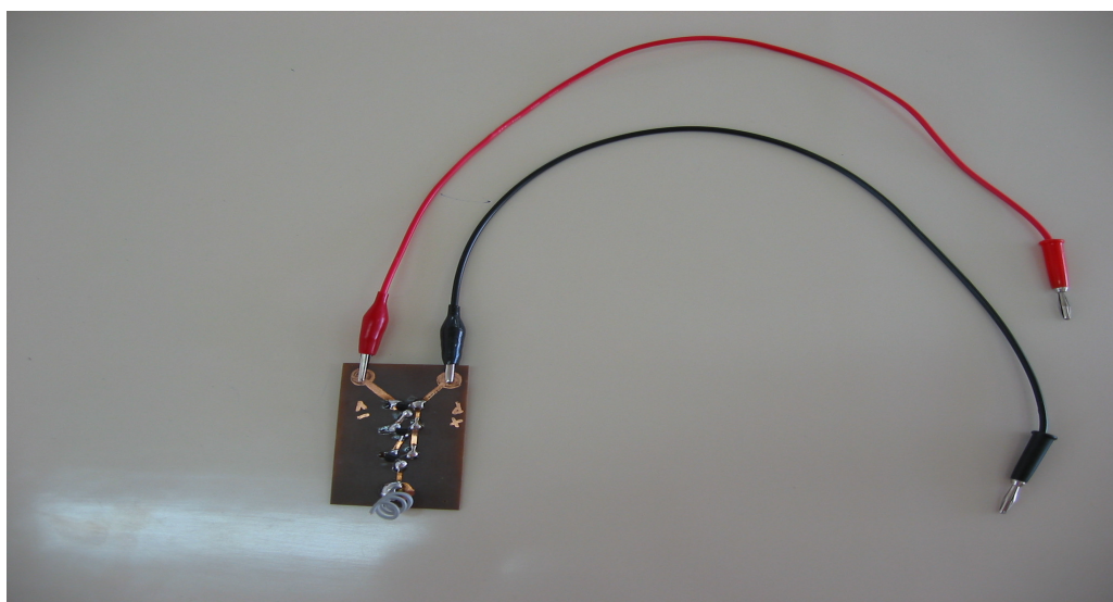
Figura 4 – Circuito impresso com os transistores, a antena e as ponteiras
